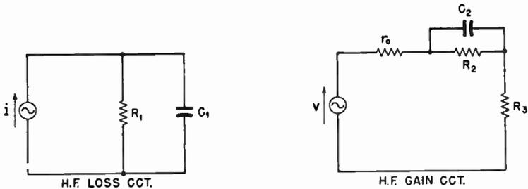
THEORETICAL ELECTRICAL EQUIVALENT OF THE BASIC VIDEO CIRCUIT
