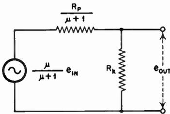
**THEORETICAL ELECTRICAL EQUIVALENT OF THE OUTPUT CIRCUIT OF THE CATHODE FOLLOWER**
