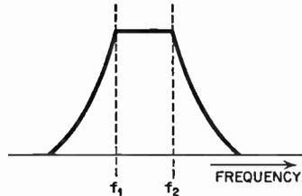
**THE TRANSMISSION CHARACTERISTIC OF THE CONSTANT K BAND PASS FILTER**
