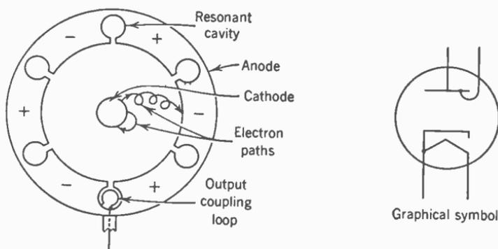
FIG. 9. Multicavity magnetron.
