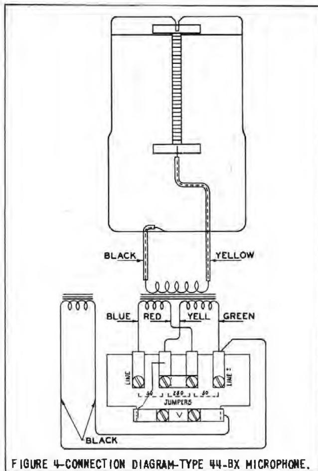
FIGURE 4—CONNECTION DIAGRAM—TYPE 44-BX MICROPHONE.
