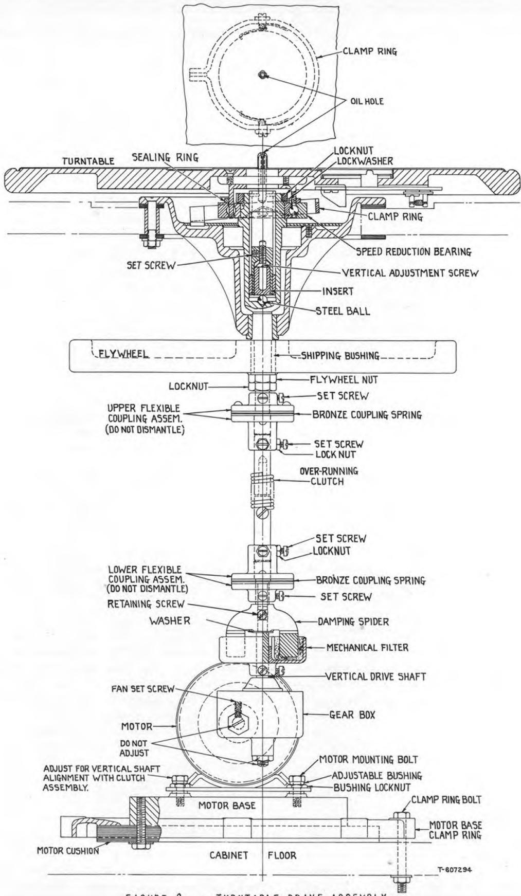
FIGURE 2 - TURNTABLE DRIVE ASSEMBLY.
