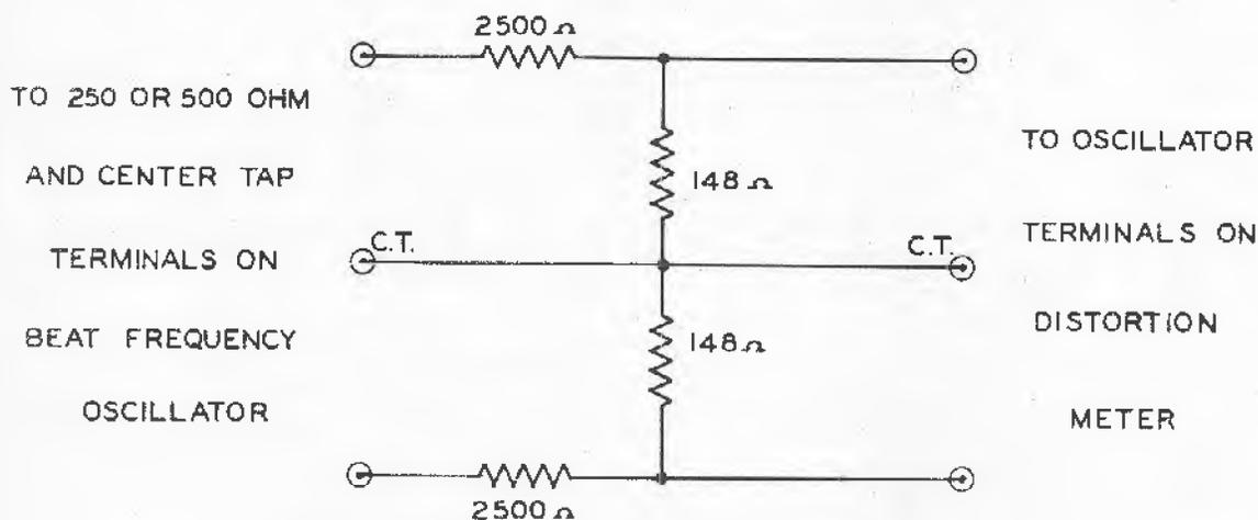
FIGURE 1 - TYPICAL ATTENUATOR
