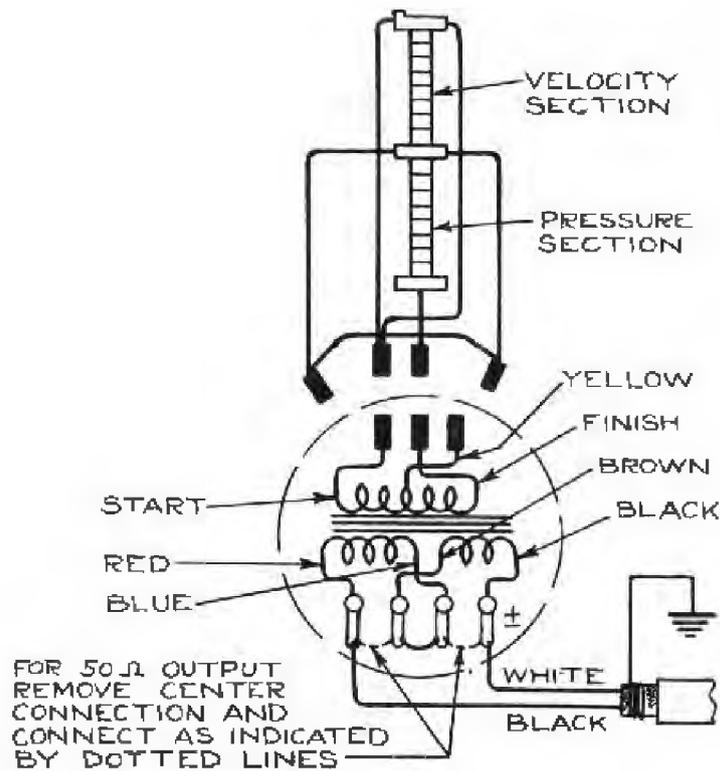
FIGURE 3 - MICROPHONE CIRCUIT
