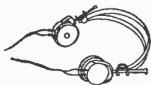
FIG. 19.—THE HEAD TELEPHONES OR RECEIVERS.
