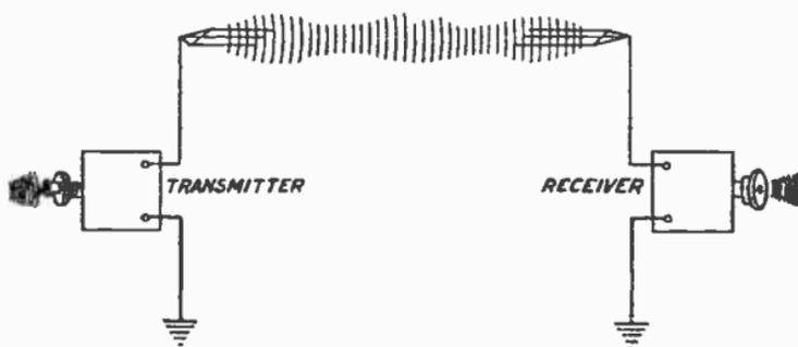
FIG. 1.—ELEMENTS OF A RADIO TELEPHONE SYSTEM.
