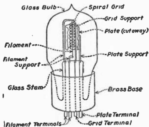
FIG. 47.—THE THREE ELEMENT VACUUM TUBE.
