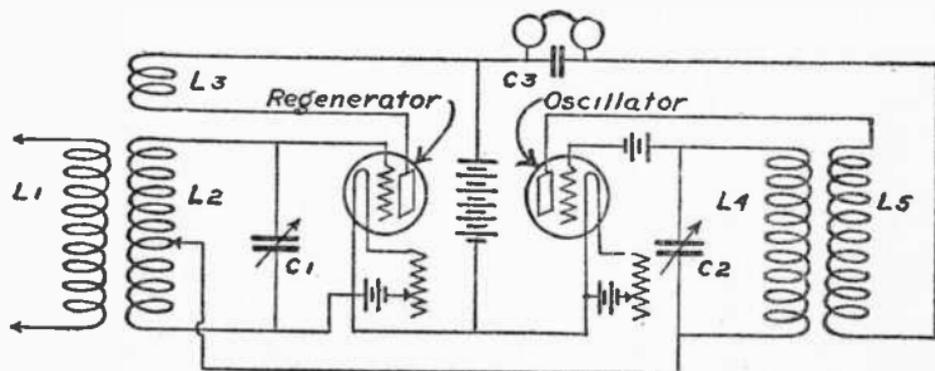
FIG. 74. ARMSTRONG SUPER-REGENERATIVE CIRCUIT. SUITABLE FOR RADIOPHONE RECEPTION.
