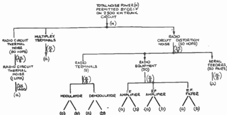
FIG. 1.—DISTRIBUTION OF NOISE IN A TYPICAL BROAD-BAND SYSTEM.
