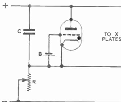
FIG. 39.—SIMPLE TIME-BASE CIRCUIT.
