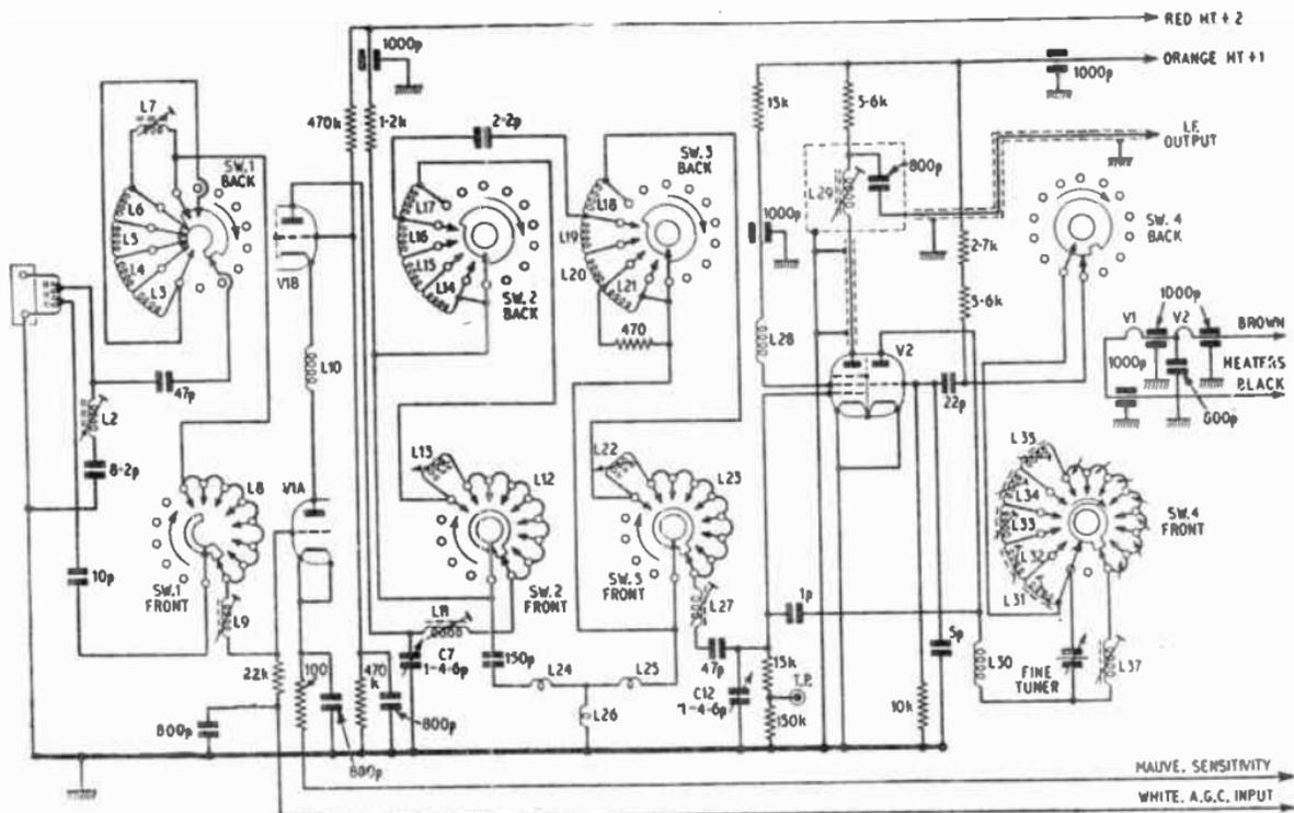
FIG. 5.—BAND I/III TUNER UNIT OF THE INCREMENTAL SWITCH TYPE.
