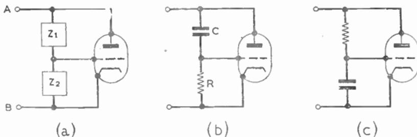
FIG. 21.—REACTANCE VALVE CIRCUITS.
