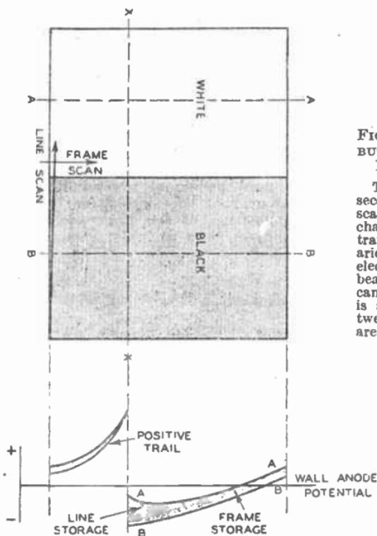
FIG. 26.—POTENTIAL DISTRIBUTION ON THE TARGET OF THE MIDGET SUPER EMITRON.
