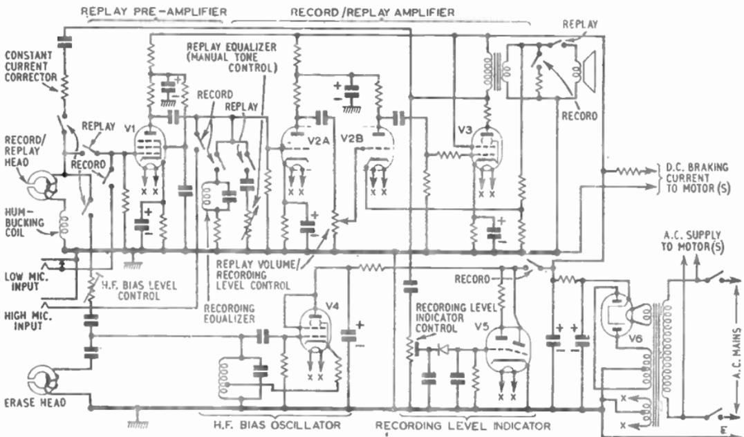
FIG. 20. REPRESENTATIVE CIRCUIT OF A DOMESTIC TAPE RECORDER.
