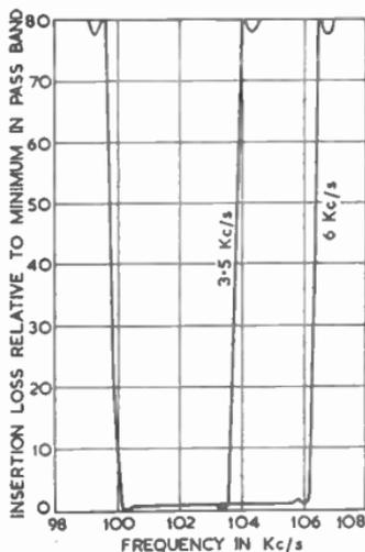
FIG. 21.—UPPER SIDEBAND FILTER RESPONSE CURVES.
