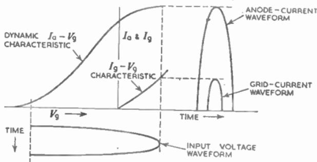
FIG. 4.—ILLUSTRATING CLASS B OPERATION.
