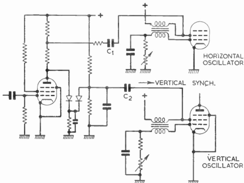
FIG. 32.—ARRANGEMENT OF CIRCUITS FOR TRIGGERED SYNCHRONIZATION.
