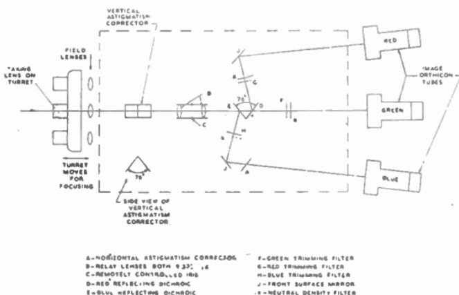
FIG. 1—COLOUR CAMERA OPTICAL SYSTEM.
