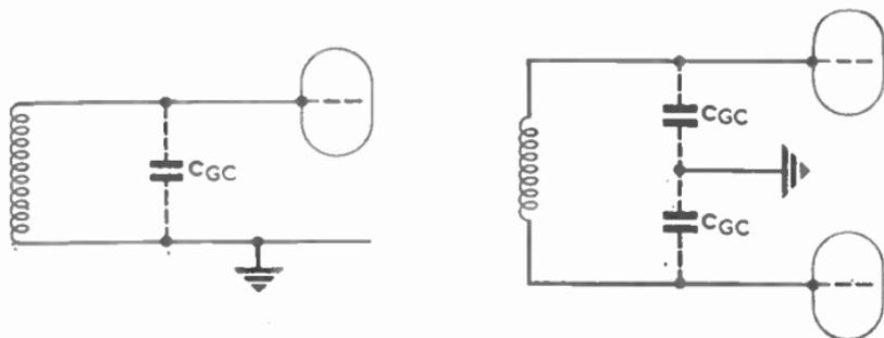
FIG. 7.—EFFECT OF INTER-ELECTRODE CAPACITANCE ON TUNED CIRCUITS.
