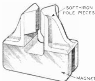
FIG. 2.—TYPICAL RIBBON-TYPE MAGNET FOR LOUDSPEAKERS.
