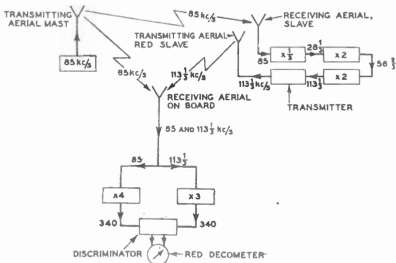
FIG. 15.—FREQUENCY MODIFICATION IN THE DECCA SYSTEM.
