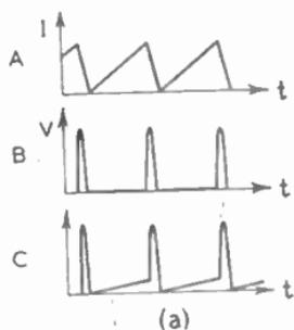
FIG. 44.—OPERATION OF THE EFFICIENCY DIODE.
