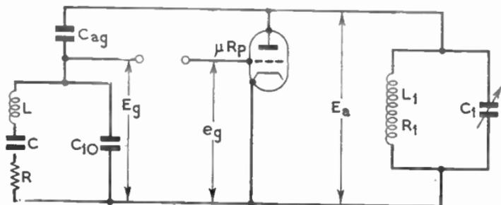
FIG. 7.—THE EQUIVALENT CIRCUIT OF THE MILLER-PERCE OSCILLATOR.
