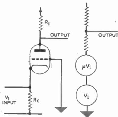
FIG. 14.—BASIC AND EQUIVALENT CIRCUITS OF GROUNDED-GRID AMPLIFIER.
