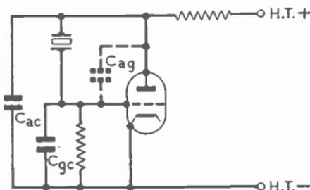
FIG. 11.—CRYSTAL COLPITTS CIRCUIT.
