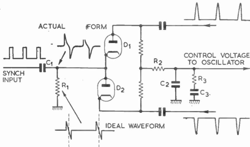
FIG. 33.—TYPICAL AUTOMATIC PHASE-CONTROL DISCRIMINATION CIRCUIT.
