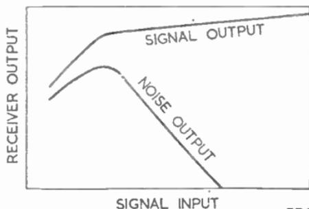
FIG. 8.—IDEAL AUTOMATIC-GAIN-CONTROL CURVE.
