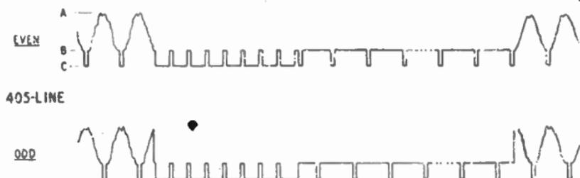
FIG. 3.—BRITISH STANDARD 405-LINE SYSTEM WAVEFORM CHARACTERISTICS.
