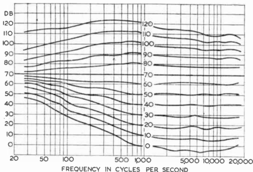
FIG. 2.—DIFFERENCES BETWEEN FLETCHER-MUNSON EQUAL LOUDNESS CONTOURS PLOTTED FROM THE 70-PHON CONTOUR.
