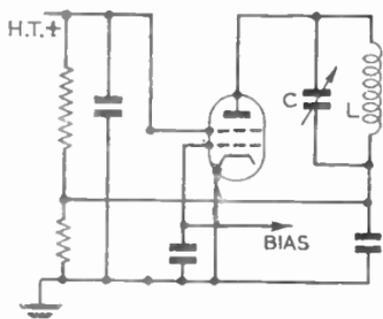
FIG. 2.—DYNATRON OSCILLATOR.
