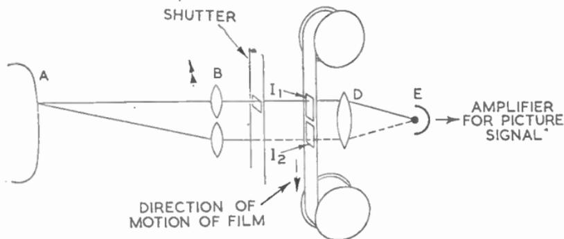
FIG. 16.—THE FLYING-SPOT FILM SCANNER.
