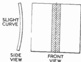
FIG. 23.—PRACTICAL ARRANGEMENT TO GIVE EVEN SOUND DISTRIBUTION.
