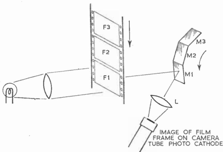
FIG. 15.—THE PRINCIPLE OF THE CONTINUOUS-MOTION PROJECTOR.
