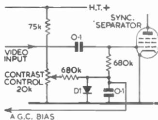
FIG. 49.—MEAN LEVEL A.G.C. SYSTEM SAMPLING SIGNAL AT GRID OF SYNC. SEPARATOR. D1 IS A DELAY DIODE.
