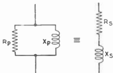
FIG. 12.—EQUIVALENCE OF SERIES AND PARALLEL COMPLEX CIRCUITS.
