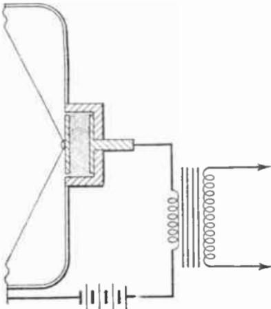
FIG. 4.—CARBON MICROPHONE AND CIRCUIT.
