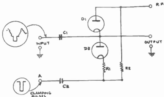
FIG. 58.—ONE FORM OF SYNCHRONIZING PULSE PEAK-LEVEL CLAMP.
