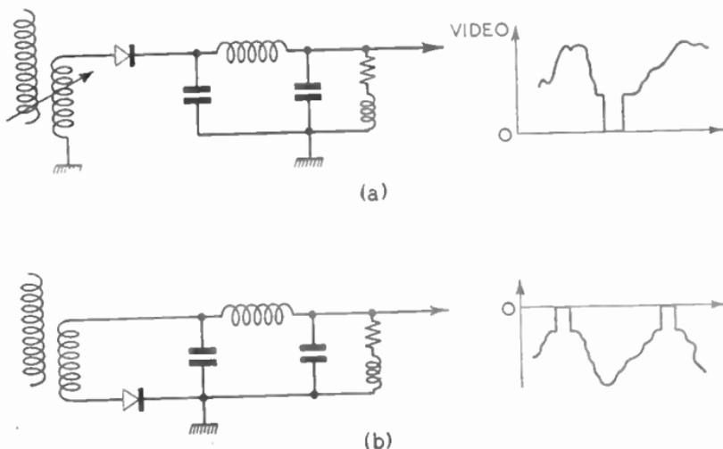
FIG. 24.—TYPICAL VIDEO DETECTOR CIRCUITS.
