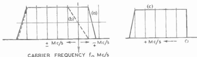
FIG. 2.—IDEALIZED R.A. SYSTEM OF V.S.B. TRANSMISSION AND RECEPTION.
