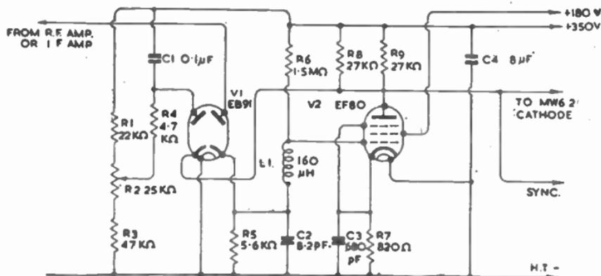
FIG. 5.—VIDEO OUTPUT STAGE USING EF80.
