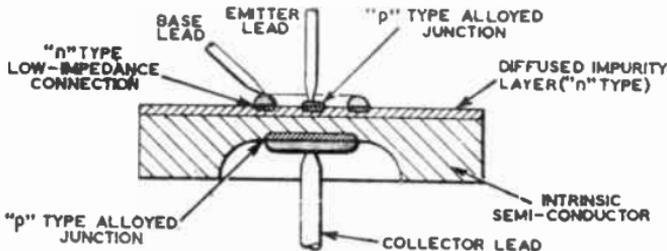
FIG. 5.—*pnip*-TYPE TRANSISTOR.
