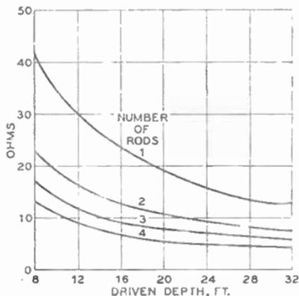
FIG. 17.—EARTH RESISTANCE OF A 1/8-IN. ROD.
