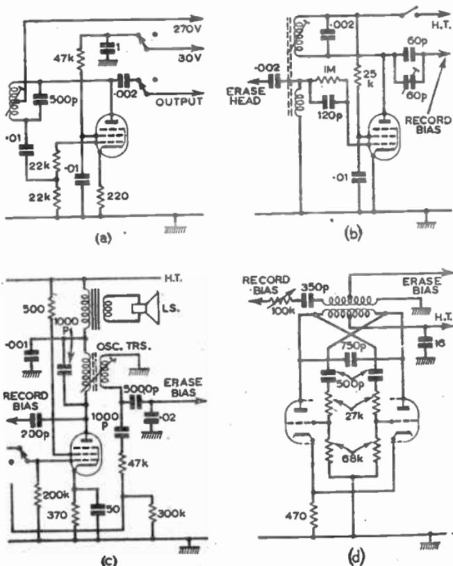
FIG. 22.—TYPICAL BIAS OSCILLATOR CIRCUITS.
