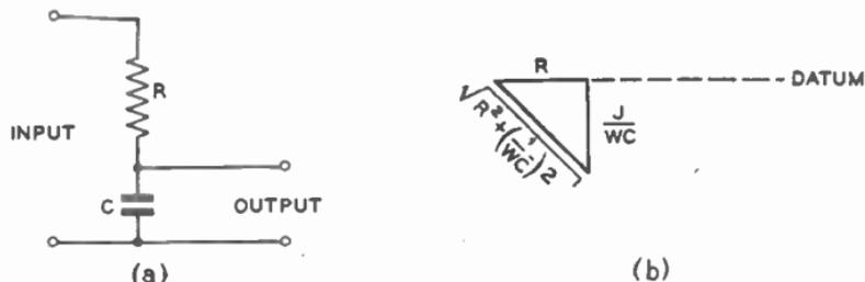
FIG. 35.—RESISTANCE/CAPACITANCE FILTER: (a) CIRCUIT; (b) VECTOR.
