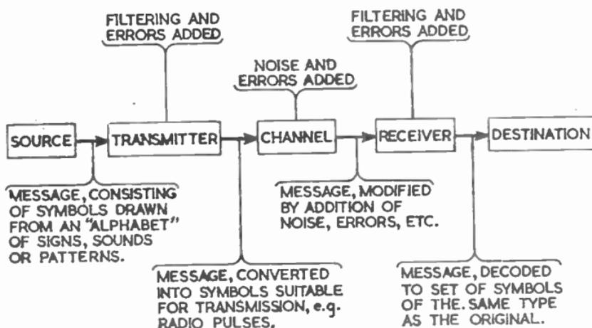
FIG. 1.—BLOCK DIAGRAM OF A COMMUNICATION SYSTEM.
