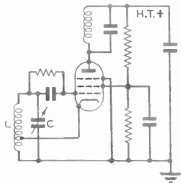
FIG. 4.—ELECTRON-COUPLED OSCILLATOR.
