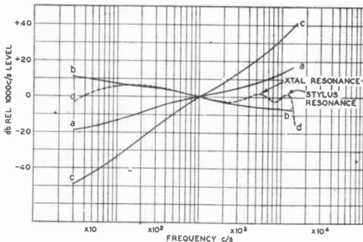
FIG. 13.—EFFECT OF CRYSTAL TERMINATION ON OUTPUT FROM FINE GROOVE RECORDINGS.
