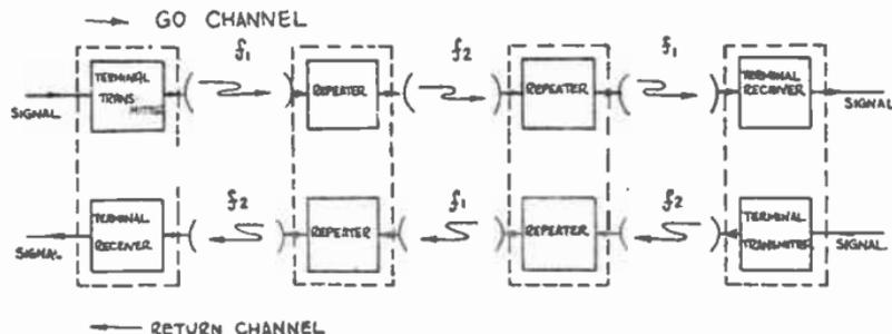
FIG. 2.—FREQUENCY PLAN FOR A BROAD-BAND RADIO SYSTEM.
