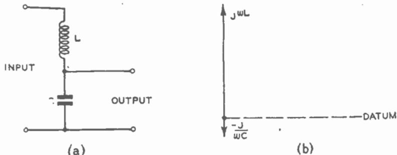
FIG. 37.—INDUCTANCE CAPACITANCE FILTER: a) CIRCUIT; (b) VECTOR.
