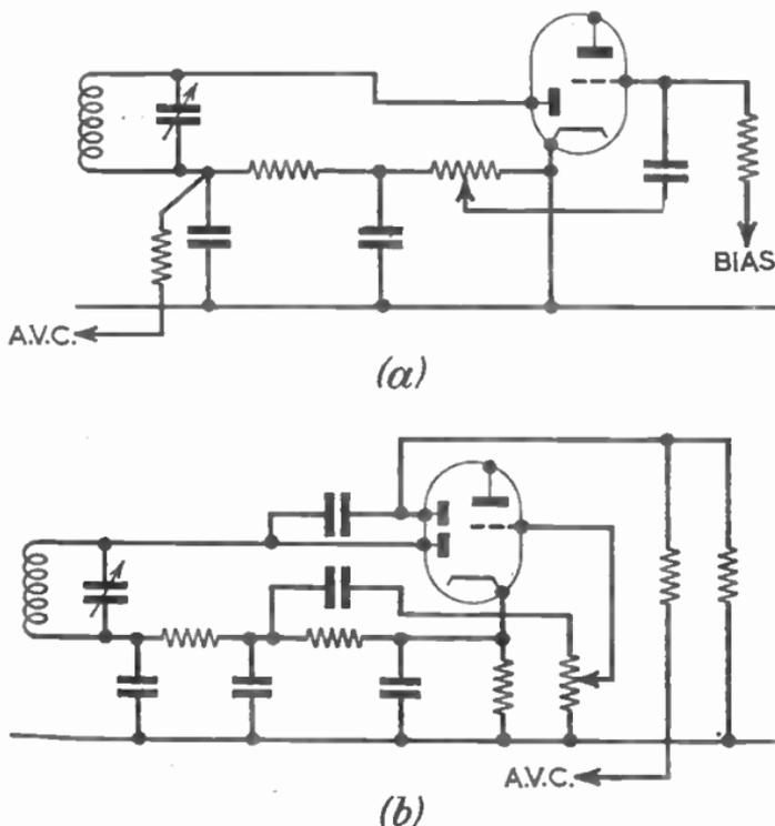
FIG. 14.—TYPICAL A.V.C. CIRCUITS
