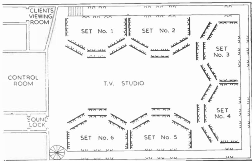
FIG. 13.—TYPICAL STUDIO LIGHTING SCHEME FOR SIX SETS.
