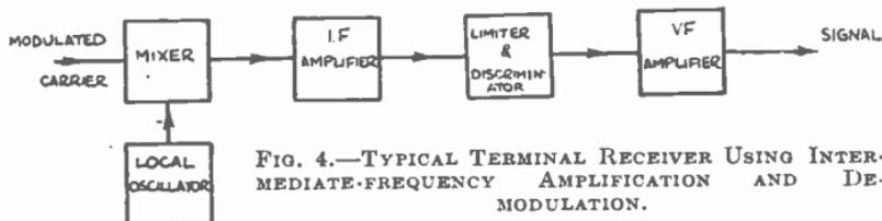
FIG. 4.—TYPICAL TERMINAL RECEIVER USING INTERMEDIATE-FREQUENCY AMPLIFICATION AND DEMODULATION.
