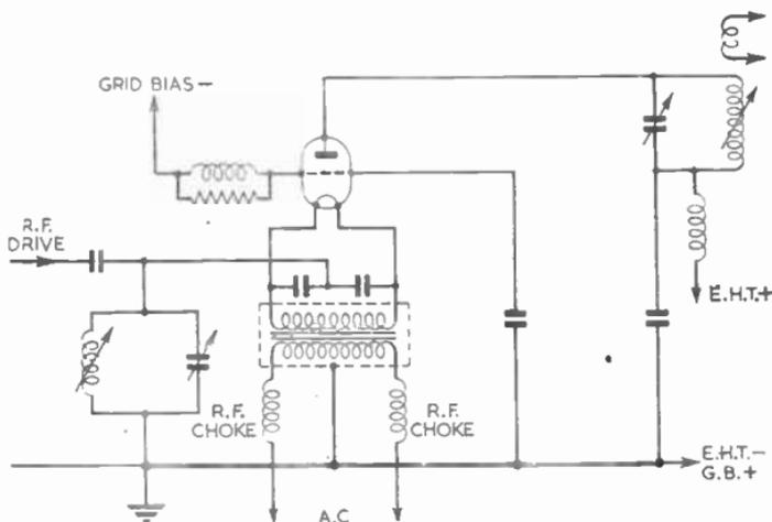
FIG. 23.—GROUNDED-GRID LINEAR RADIO-FREQUENCY POWER AMPLIFIER CIRCUIT.
