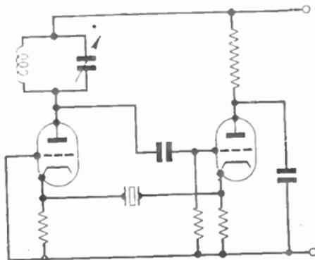
FIG. 16.—BUTLER OSCILLATOR CIRCUIT.
