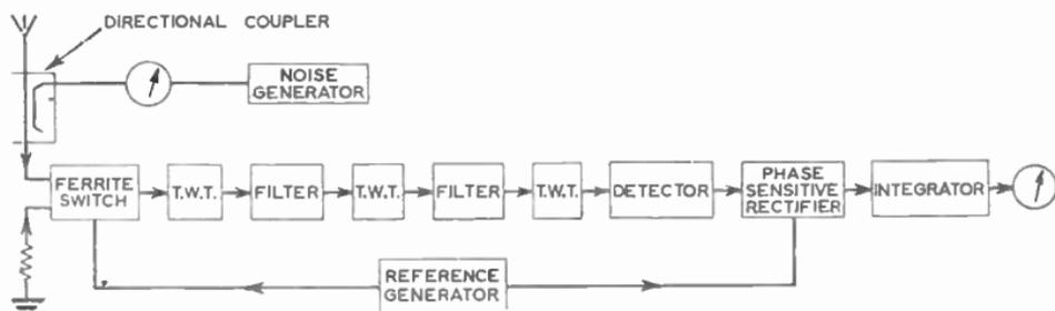
FIG. 13.—DRAKE AND EWEN TRAVELLING-WAVE TUBE RECEIVER WITH "NOISE COMPENSATION".
