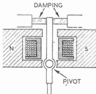
FIG. 9.—MOVING-IRON SYSTEM.
