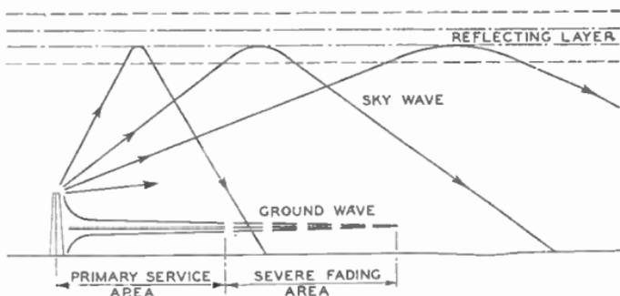
FIG. 2.—GROUND WAVE AND SKY WAVE.
