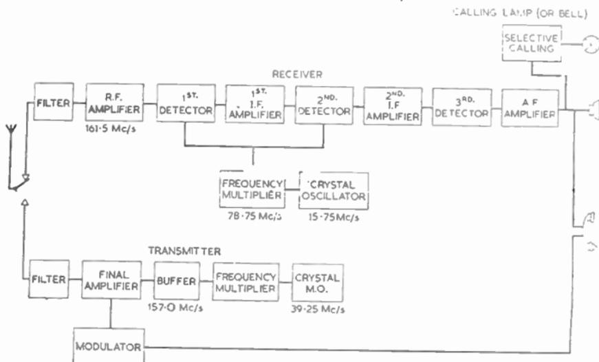
FIG. 7.—TYPICAL MOBILE V.H.F., A.M., TRANSMITTER/RECEIVER.
