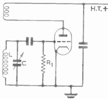
FIG. 1.—SIMPLE OSCILLATOR.
