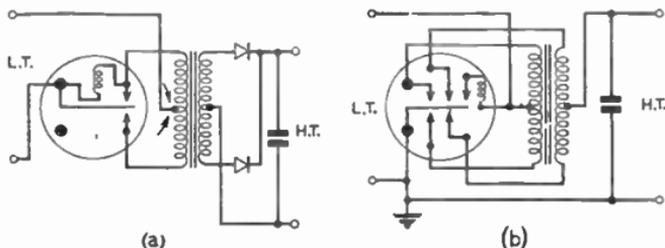
FIG. 46.—VIBRATOR POWER UNITS.
