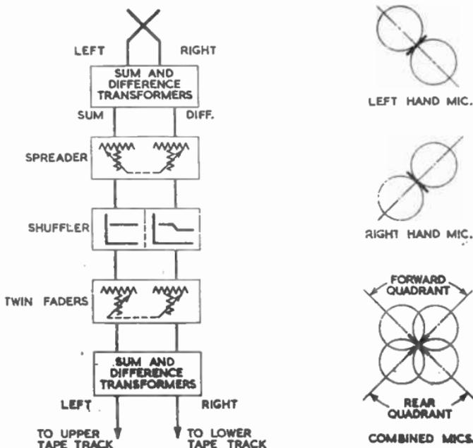
FIG. 23.—ONE ARRANGEMENT OF THE "STEREOSONIC" RECORDING SYSTEM. MICROPHONE POLAR RESPONSES ARE SHOWN ON THE RIGHT.
