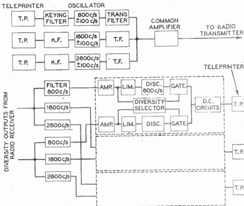
FIG. 7.—F.M.V.F. BLOCK DIAGRAM.
