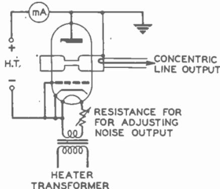
FIG. 5.— TYPICAL CIRCUIT OF NOISE KLYSTRON.
