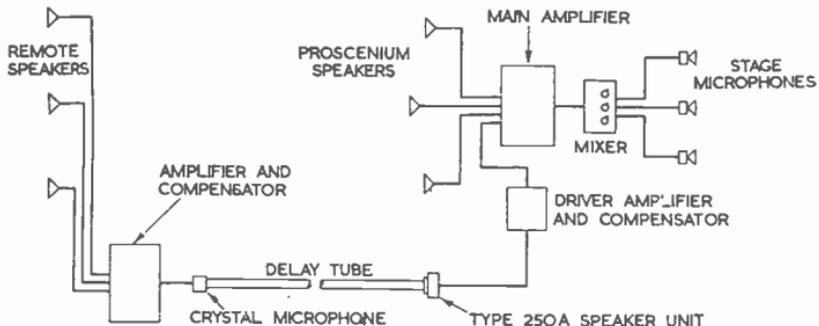
FIG. 27 —BLOCK DIAGRAM OF THE B.T.H. SOUND DELAY SYSTEM.
