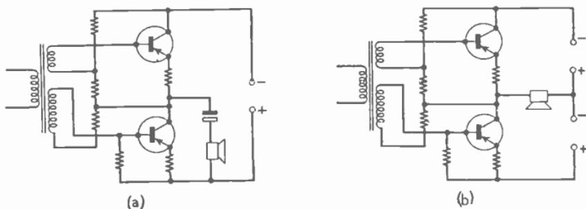
FIG. 45.—" SINGLE-ENDED " PUSH-PULL OUTPUT CIRCUITS.
