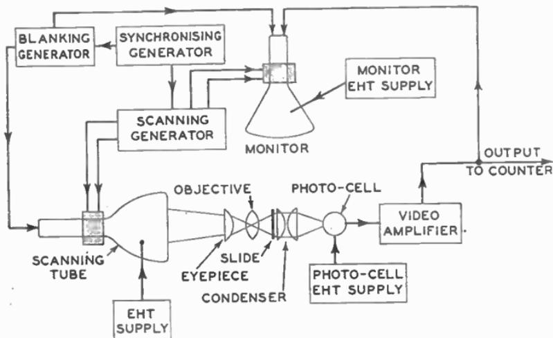
FIG. 15.—BLOCK DIAGRAM OF A FLYING-SPOT MICROSCOPE.
