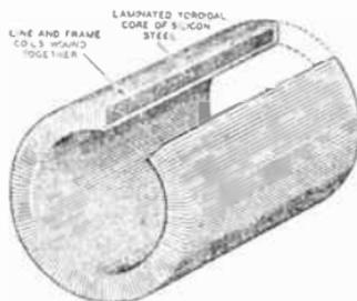
FIG. 21.—TOROIDAL DEFLECTING-YOKE CUT AWAY TO SHOW LAMINATED STEEL CORE.
