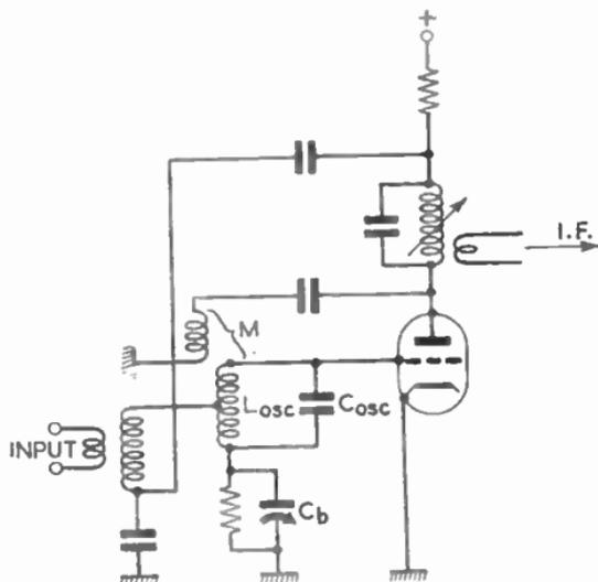
FIG. 9.—ALTERNATIVE FORM OF SELF-OSCILLATING MIXER.
