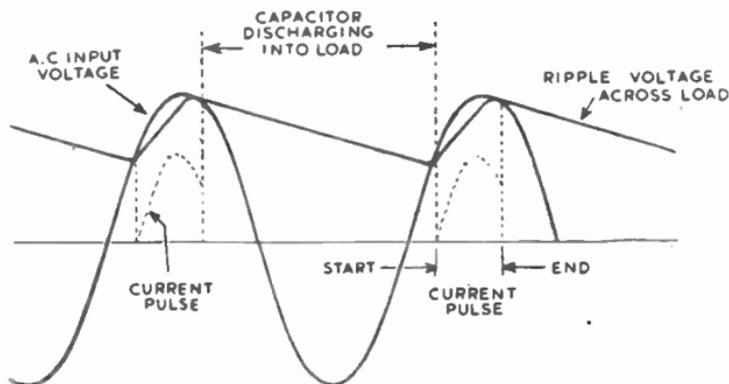
FIG. 9.—APPROXIMATE WAVEFORMS IN HALF-WAVE CAPACITOR INPUT CIRCUIT.
