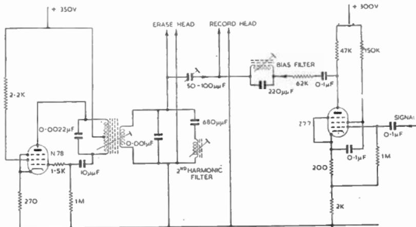
FIG. 4.—OSCILLATOR AND BIAS CIRCUIT OF THE E.M.I. TYPE TR50 TAPE RECORDER.
