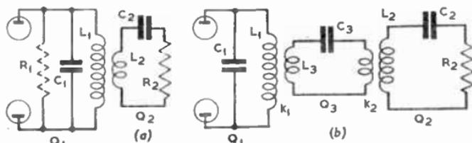
FIG. 12.—(a) DOUBLE-TUNED COUPLED CIRCUITS; (b) TRIPLE-TUNED CIRCUITS.
