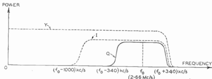
FIG. 24.—SPECTRUM OF THE COMPOSITE VIDEO SIGNAL.
