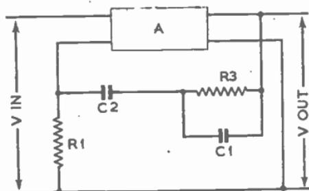
FIG. 13.—EQUALIZING CONFIGURATION IN A NEGATIVE FEEDBACK LOOP.
