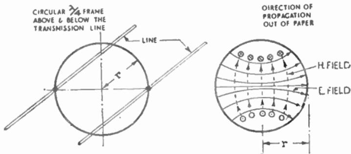
FIG. 10.—DEVELOPMENT OF SIMPLE WAVE MODE FOR CYLINDRICAL GUIDE.
