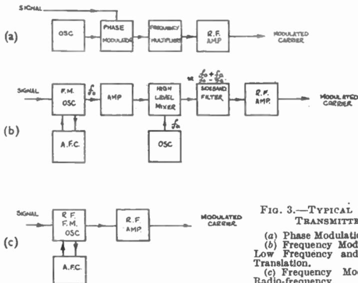
FIG. 3.—TYPICAL TERMINAL TRANSMITTERS.
