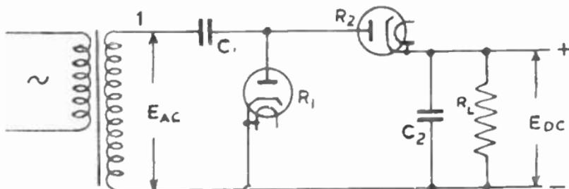
FIG. 12.—HALF-WAVE VOLTAGE DOUBLER CIRCUIT.
