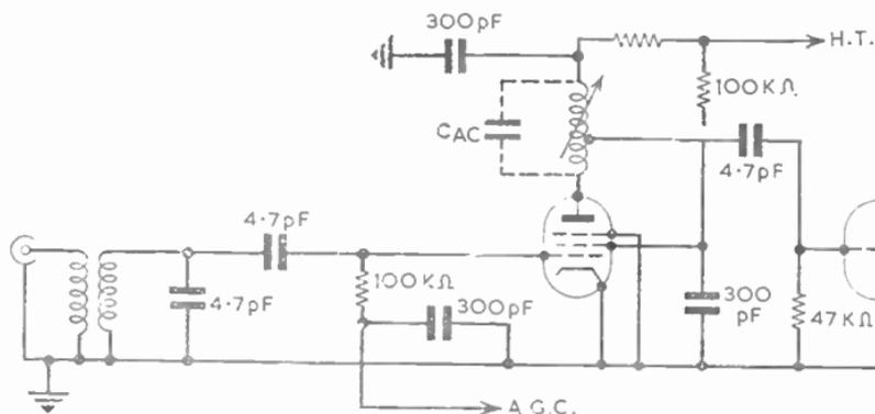
FIG. 24.—V.H.F. AMPLIFIER CIRCUIT.
