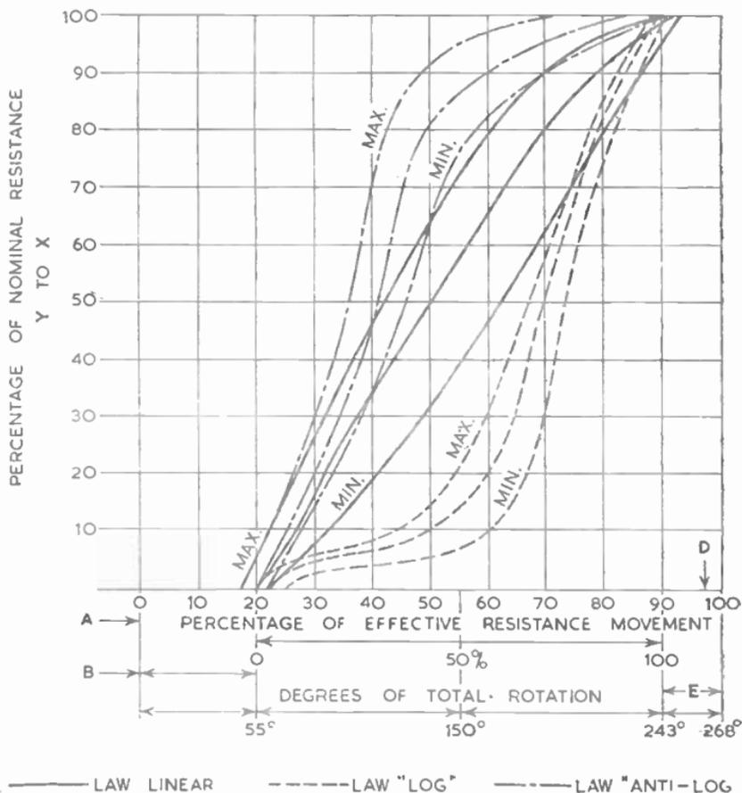
FIG. 2.—RESISTANCE LAW LIMITS FOR CARBON-TRACK POTENTIOMETERS.
