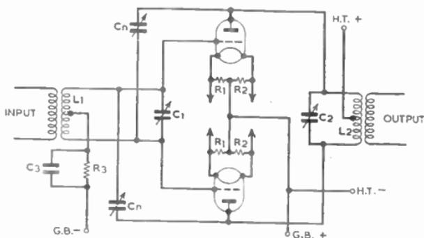
FIG. 14.—SIMPLIFIED CIRCUIT DIAGRAM OF TYPICAL HIGH-POWER TRANSMITTER RADIO-FREQUENCY STAGE USING TWO NEUTRALIZED TRIODES IN PUSH-PULL.
