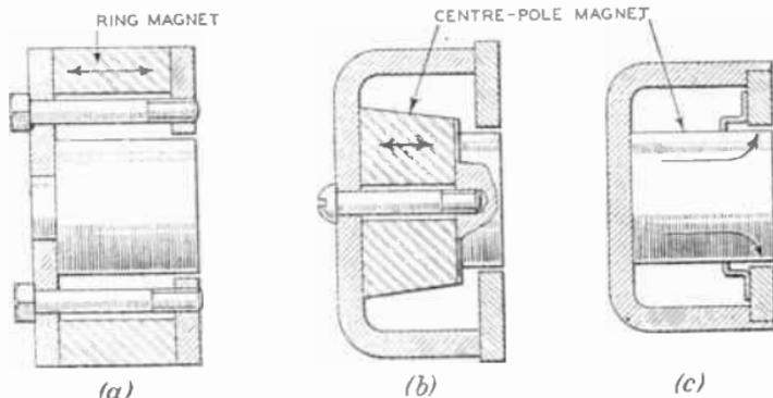
FIG. 1.—TYPICAL FORMS OF LOUDSPEAKER MAGNETS.
