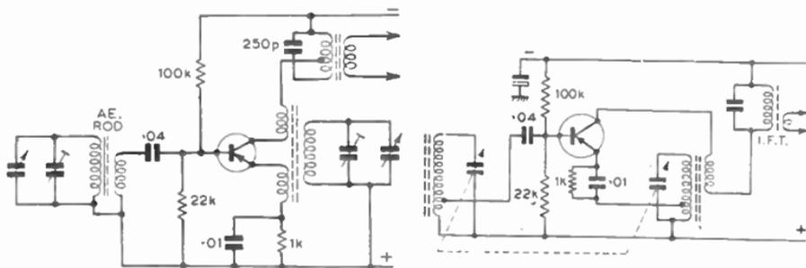
FIG. 40.—TYPICAL TRANSISTOR FREQUENCY-CHANGER CIRCUITS.
