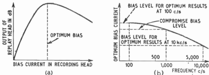
FIG. 21 (a).—SHOWS THE RELATIONSHIP BETWEEN H.F. BIAS LEVEL AND AMPLITUDE OF RECORDED SIGNAL; (b) SHOWS THE RELATIONSHIP BETWEEN THE OPTIMUM H.F. BIAS LEVEL AND THE FREQUENCY OF THE RECORDED SIGNAL.
