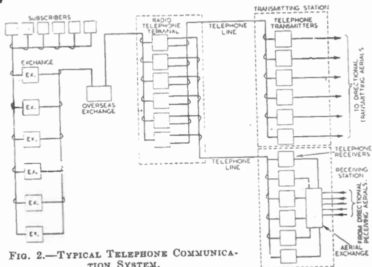
FIG. 2.—TYPICAL TELEPHONE COMMUNICATION SYSTEM.
