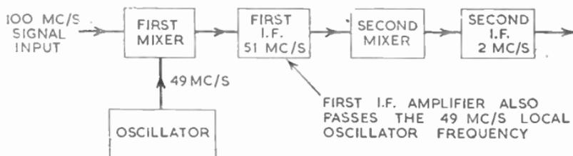
FIG. 25.—BLOCK DIAGRAM OF A DOUBLE MIXER.
