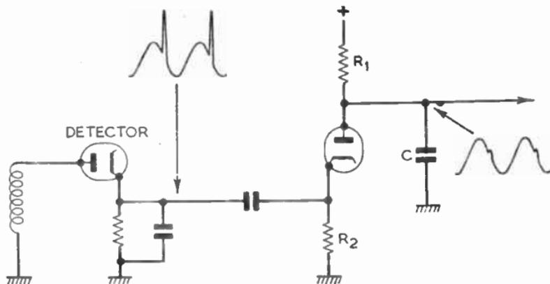
FIG. 52.—"FOLLOWING LIMITER" CIRCUIT.
