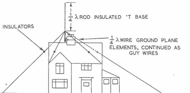
FIG. 9.—VERTICAL GROUND PLANE SHORT-WAVE AERIAL.
