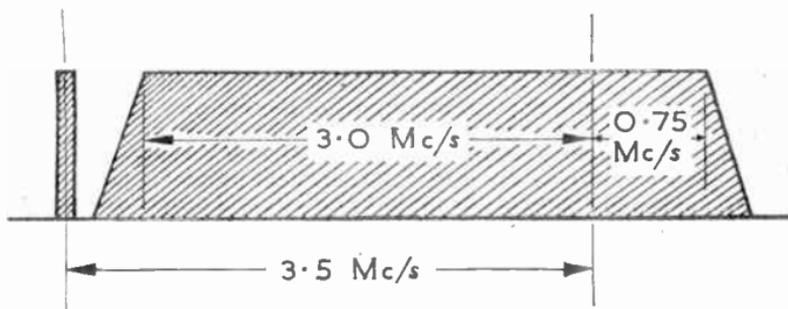
FIG. 17.—VESTIGIAL SIDEBAND TRANSMISSION CURVE.
