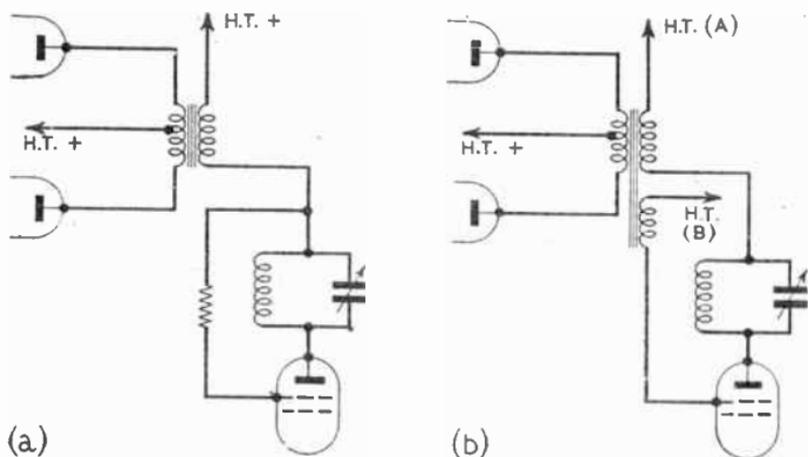
FIG. 16.—ANODE-MODULATION CIRCUITS.
