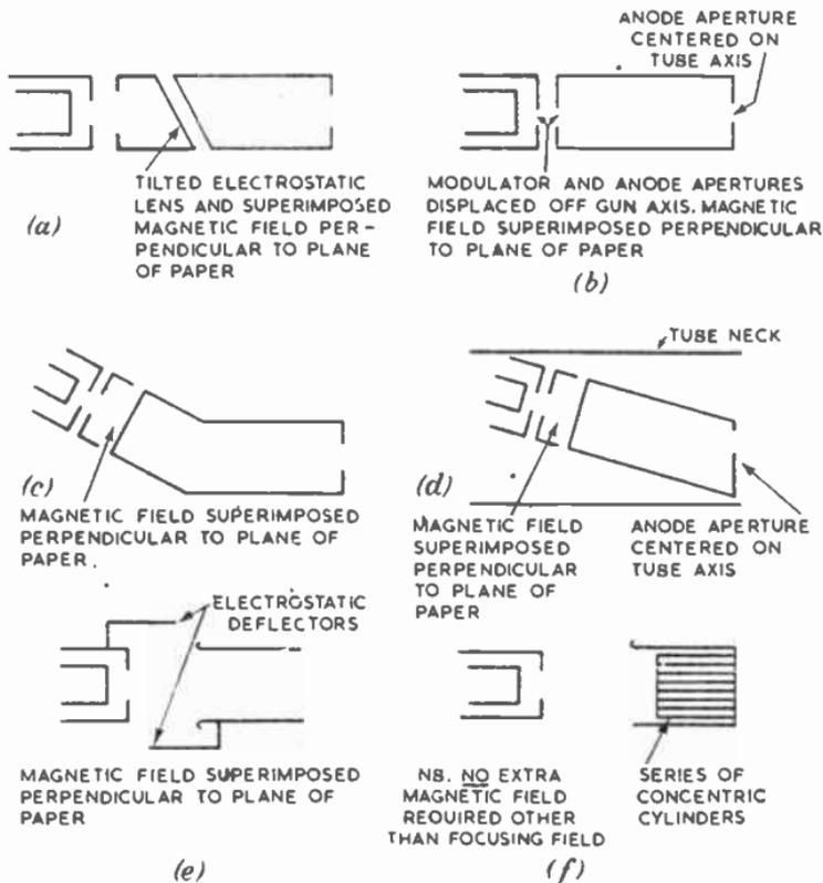
FIG. 22.—ION-TRAP DESIGNS.
