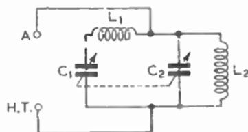
FIG. 4.—MULTIPLE TUNING ARRANGEMENT FOR SINGLE-ENDED OUTPUT.
