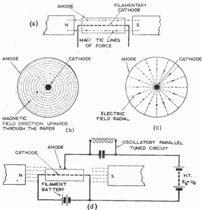
FIG. 18.—ORIGINAL CYLINDRICAL ANODE MAGNETRON.
