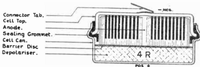
FIG. 8 (a).—ROLLED-ANODE TYPE CELL.
