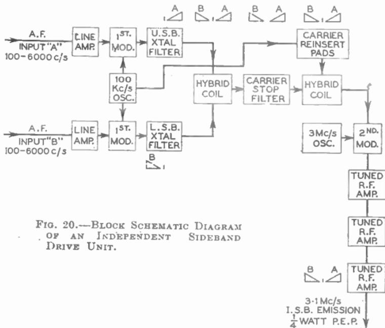
FIG. 20.—BLOCK SCHEMATIC DIAGRAM OF AN INDEPENDENT SIDEBAND DRIVE UNIT.
