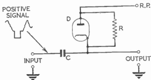
FIG. 56 (a).—SIMPLE D.C. RESTORATION CIRCUIT FOR POSITIVE PICTURE SIGNALS.
