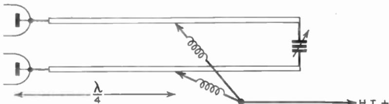
FIG. 10.—HALF-WAVE LINE USED AS A CIRCUIT ELEMENT.
