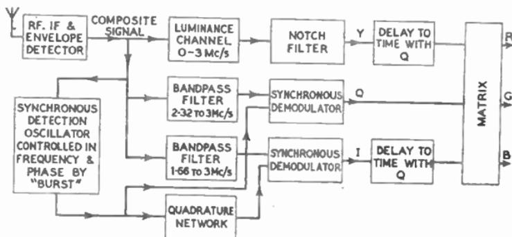
FIG. 25.—RECEIVER BLOCK DIAGRAM.
