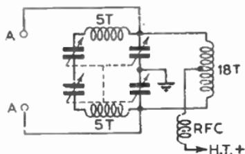
FIG. 5.—MULTIPLE TUNING ARRANGEMENT FOR PUSH-PULL OUTPUT STAGE.
