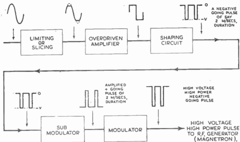
FIG. 40.—DEVELOPMENT OF HIGH-VOLTAGE, HIGH-POWER PULSES AT LOW LEVEL.
