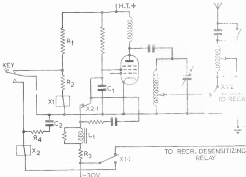
FIG. 17.—TYPICAL KEYING CIRCUIT.
