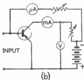
FIG. 25.—COMMON EMITTER OPERATION.
