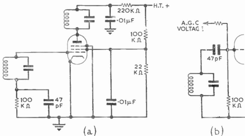
FIG. 29.—F.M. LIMITER CIRCUIT.
