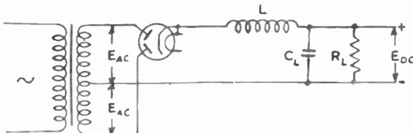
FIG. 13.—FULL-WAVE CHOKE-INPUT CIRCUIT.
