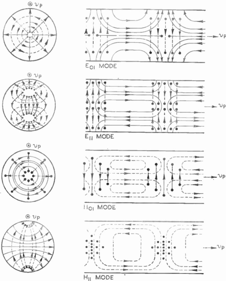
FIG. 20.—WAVE MODES IN A CYLINDRICAL GUIDE.
