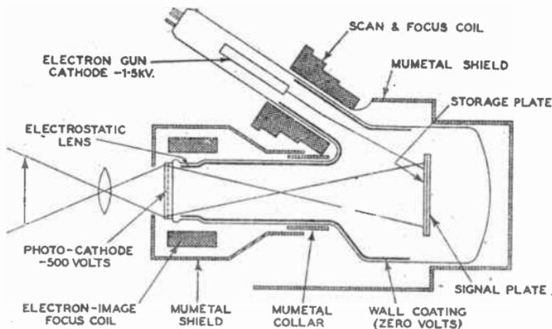
FIG. 25.—THE MIDGET SUPER EMITRON.
