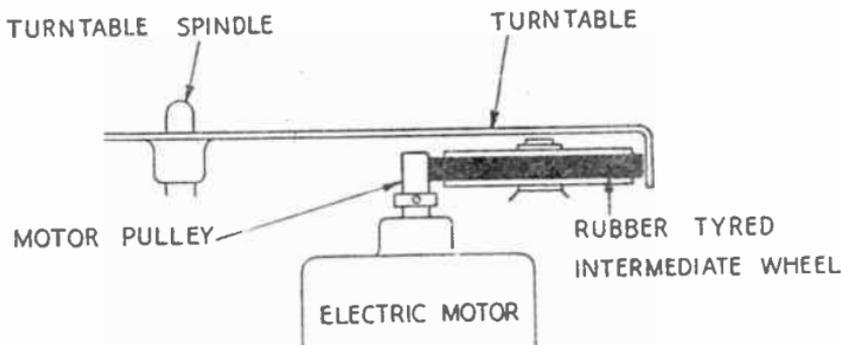
FIG. 1.—FRICTION DRIVE AS USED ON GRAMOPHONE UNITS.
