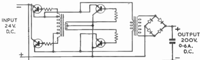
FIG. 24.—HIGH POWER CONVERTER.
