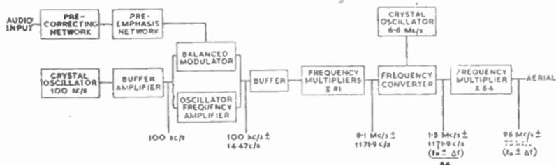
FIG. 32.—THE ARMSTRONG TYPE OF FREQUENCY MODULATION SYSTEM.
