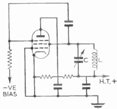
FIG. 3.—TRANSATRON OSCILLATOR.
