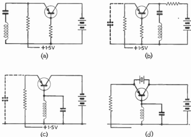
FIG. 35.—(a) POINT-CONTACT TRANSISTOR OSCILLATOR WITH SERIES TUNED EMITTER CIRCUIT. (b) POINT-CONTACT TRANSISTOR OSCILLATOR WITH SERIES TUNED COLLECTOR CIRCUIT. THE COLLECTOR RESISTANCE MAY BE REPLACED BY A RADIO-FREQUENCY CHOKE. IN SOME CASES THE EMITTER RESISTANCE SHOULD BE BY-PASSED. (c) POINT-CONTACT TRANSISTOR OSCILLATOR WITH PARALLEL TUNED CIRCUIT IN THE BASE LEAD. IN SOME CASES THE EMITTER RESISTANCE SHOULD BE BY-PASSED. (d) CRYSTAL CONTROLLED POINT-CONTACT TRANSISTOR OSCILLATOR.
