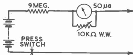
FIG. 6.—SIMPLE INSULATION TESTER.
