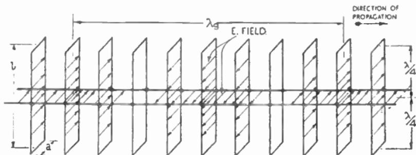
FIG. 6.—ELECTRIC FIELD DISTRIBUTION ALONG AN OPEN-WIRE TRANSMISSION LINE ENCLOSED BY  $\lambda/4$  INSULATOR FRAMES ABOVE AND BELOW THE LINE.
