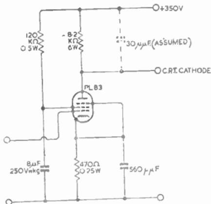
FIG. 6.—VIDEO OUTPUT STAGE USING PL83
