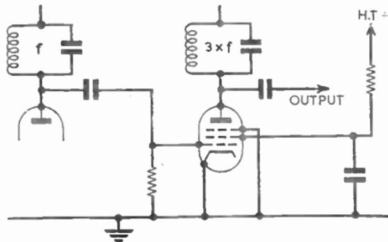
FIG. 5.—FREQUENCY-MULTIPLIER CIRCUIT.
