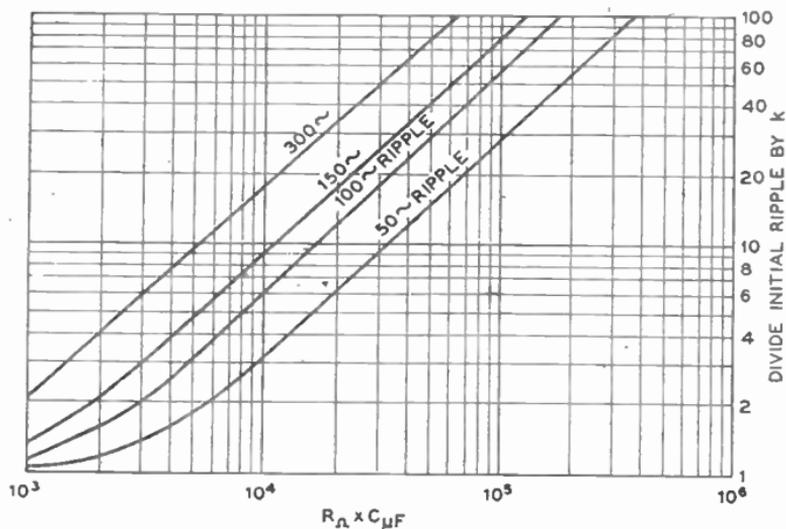
FIG. 36.—RIPPLE REDUCTION FACTOR FOR A SINGLE RESISTANCE/CAPACITANCE FILTER.
