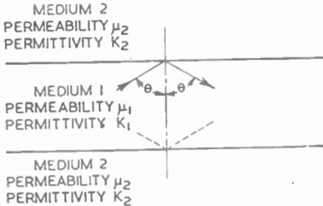
FIG. 21.—DIELECTRIC WAVEGUIDE.
