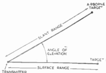
FIG. 17.—TARGET HEIGHT MEASUREMENT.
