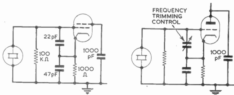
FIG. 3.—FUNDAMENTAL CRYSTAL OSCILLATOR.
