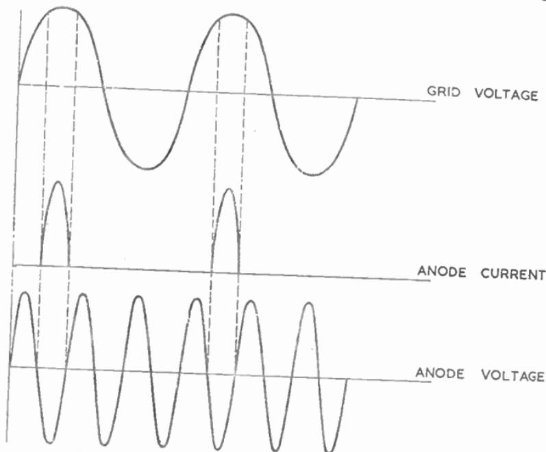
FIG. 6.—WAVEFORMS IN THE FREQUENCY MULTIPLIER.
