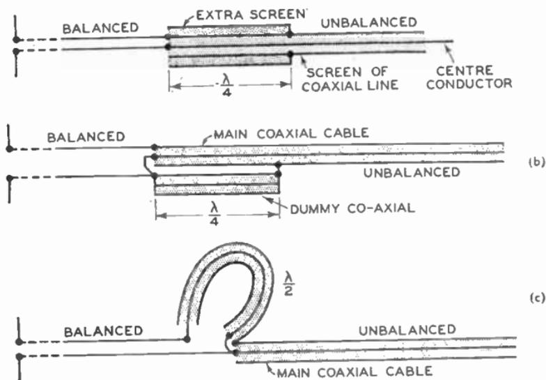
FIG. 5.—BALANCED TO UNBALANCED TRANSFORMERS.
