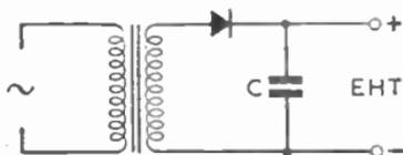
FIG. 24.—E.H.T. HALF-WAVE RECTIFIER (SINE-WAVE INPUT).
