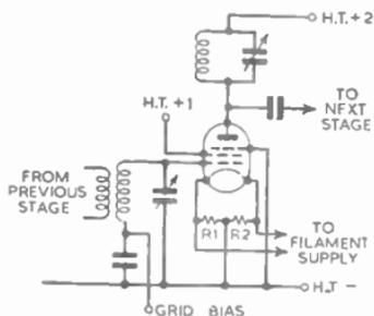
FIG. 11.—CIRCUIT DIAGRAM OF TYPICAL LOW-POWER TRANSMITTER RADIO-FREQUENCY STAGE USING A PENTODE.
