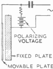
FIG. 2.—CONDENSER TYPE LOUDSPEAKER.
