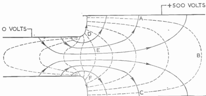
FIG. 3.—ELECTRIC FIELD (SOLID LINES) AND EQUIPOTENTIAL SURFACES (DOTTED LINES) BETWEEN TWO CO-AXIAL CHARGED CYLINDERS.
