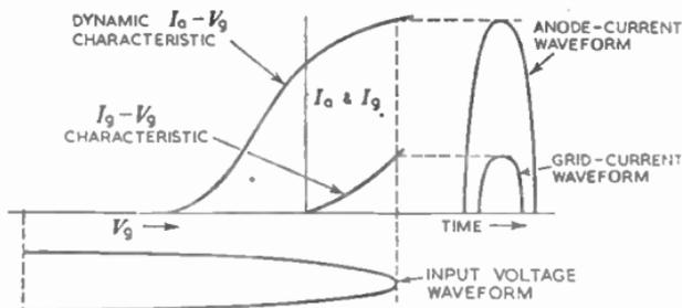
FIG. 6.—ILLUSTRATING CLASS C OPERATION.
