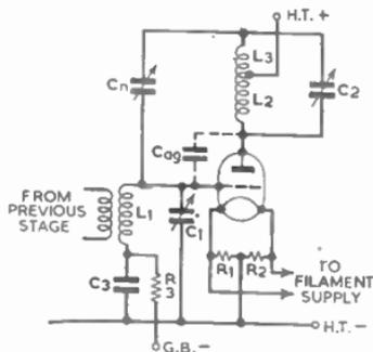
FIG. 12.—SIMPLIFIED CIRCUIT DIAGRAM OF TYPICAL HIGH-POWER TRANSMITTER CURRENT-FREQUENCY STAGE USING A NEUTRALIZED TRIODE.
