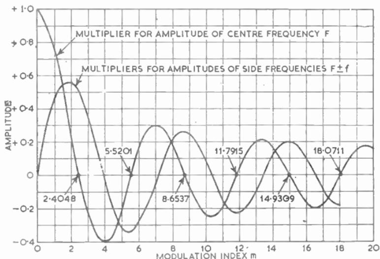
FIG. 27.—VARIATION OF CARRIER AND SIDEBAND AMPLITUDES IN FREQUENCY-MODULATED SYSTEM.
