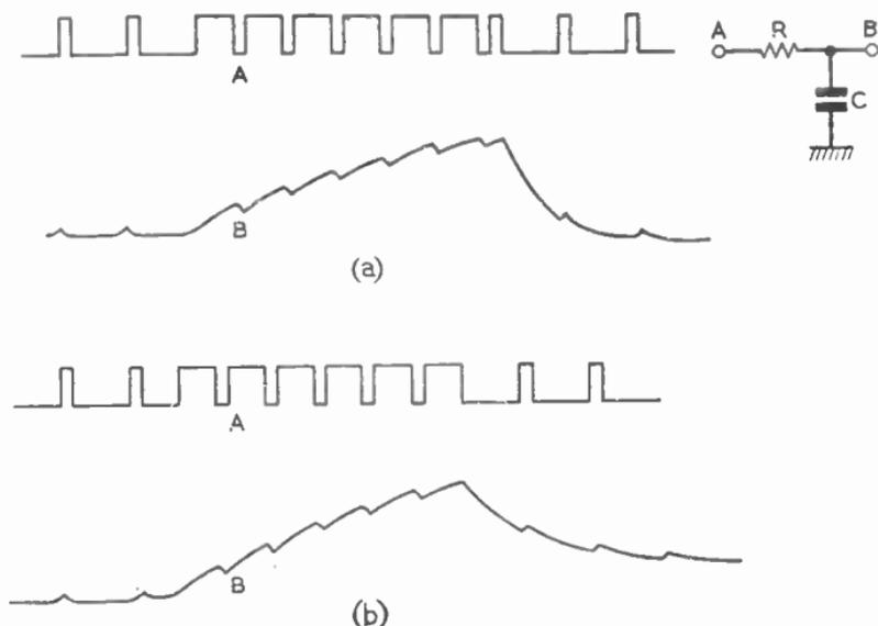
FIG. 29.—RESISTANCE-CAPACITANCE INTEGRATOR.
