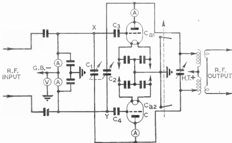
FIG. 5.—NEUTRALIZING CIRCUITS IN A PUSH-PULL RADIO-FREQUENCY AMPLIFIER.
