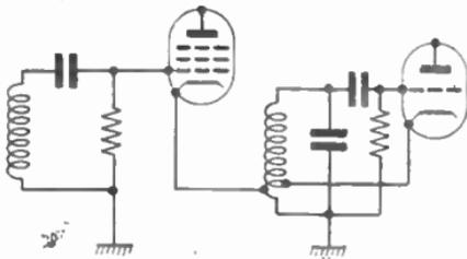
FIG. 7.—ALTERNATIVE METHOD OF COUPLING LOCAL OSCILLATOR TO PENTODE MIXER.
