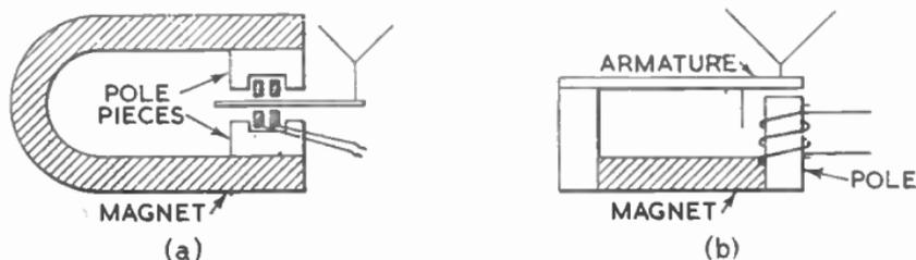
FIG. 1.—ELECTROMAGNETIC LOUDSPEAKERS.
