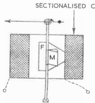
FIG. 4.—MOVING-IRON INSTRUMENT, REPULSION TYPE.
