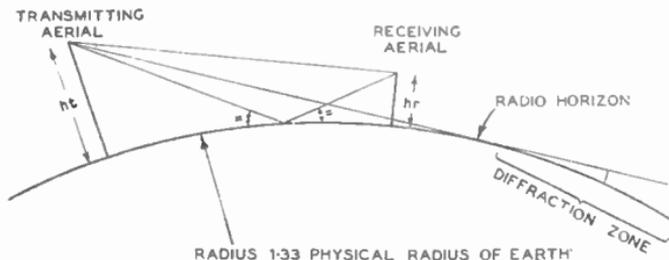
FIG. 6.—VERY-HIGH-FREQUENCY PROPAGATION.
