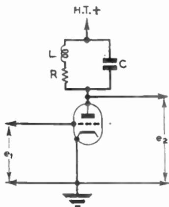
FIG. 58(a).—TUNED ANODE COUPLING.
