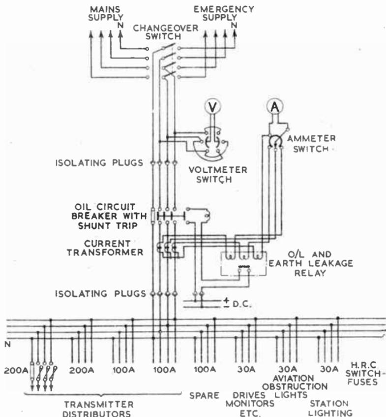
FIG. 19.—TYPICAL LOW-VOLTAGE DISTRIBUTION SWITCHBOARD FOR TRANSMITTERS.
