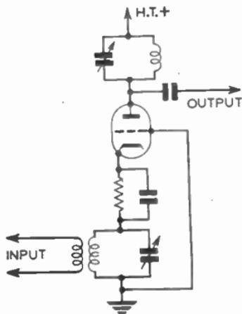
FIG. 67.—GROUNDED-GRID R.F. AMPLIFIER.
