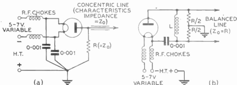
FIG. 1.—TYPICAL NOISE-DIODE CIRCUITS.
