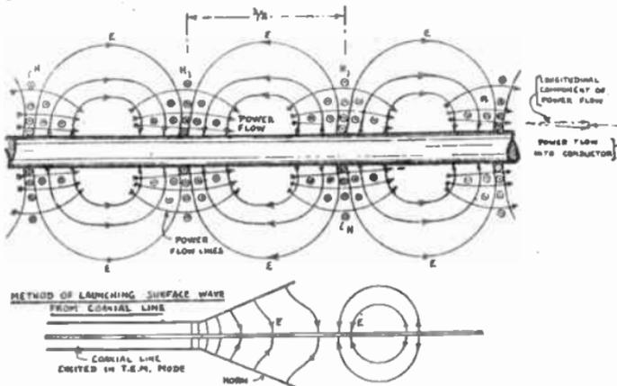
CYLINDRICAL SURFACE WAVE GUIDED BY A SINGLE CONDUCTOR
