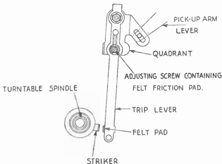
FIG. 7.—VELOCITY TYPE OF AUTOMATIC TRIP.
