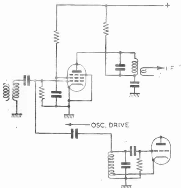
FIG. 6.—PENTODE MIXER WITH SEPARATE LOCAL OSCILLATOR.
