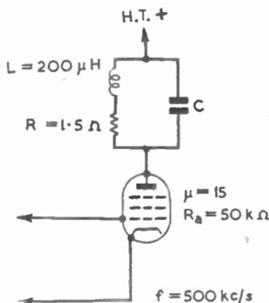
FIG. 58(b).—EXAMPLE 2, TUNED ANODE COUPLING.
