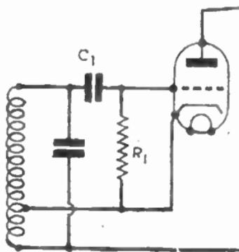
FIG. 42.—HARTLEY TYPE OSCILLATOR.
