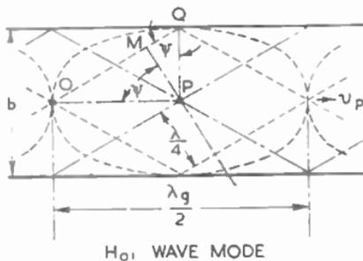
FIG. 14.— H WAVES SUPPORTED BY A HOLLOW METAL CHANNEL.
