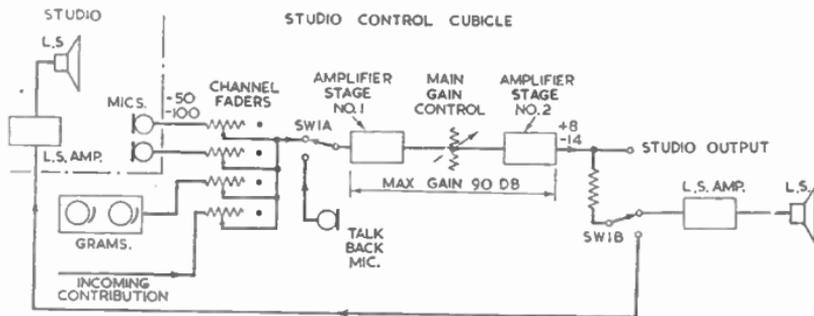
FIG. 7.—BASIC AMPLIFIER CHAIN.
