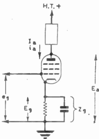
**FIG. 55.—GRID BIAS VALVE CONSTANTS.**
