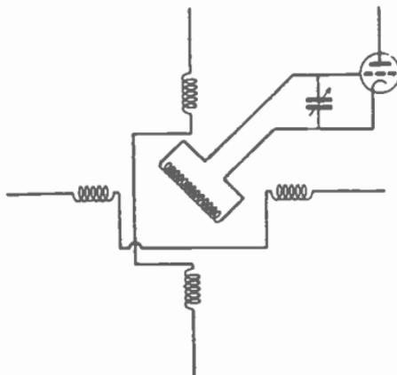
FIG. 8.—SCHEMATIC ARRANGEMENT RADIO-GONIOMETER IN BELLINI-TOSI SYSTEM.
