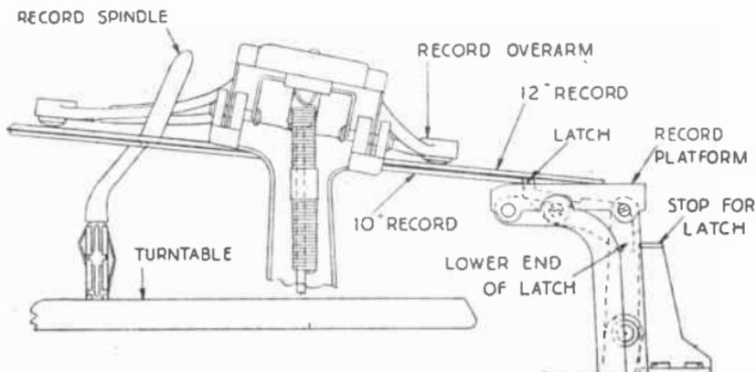
FIG. 10.—RECORD PLATFORM FOR PLAYING MIXED SIZES OF RECORDS.
