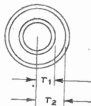
FIG. 95.—CHARACTERISTIC IMPEDANCE.
