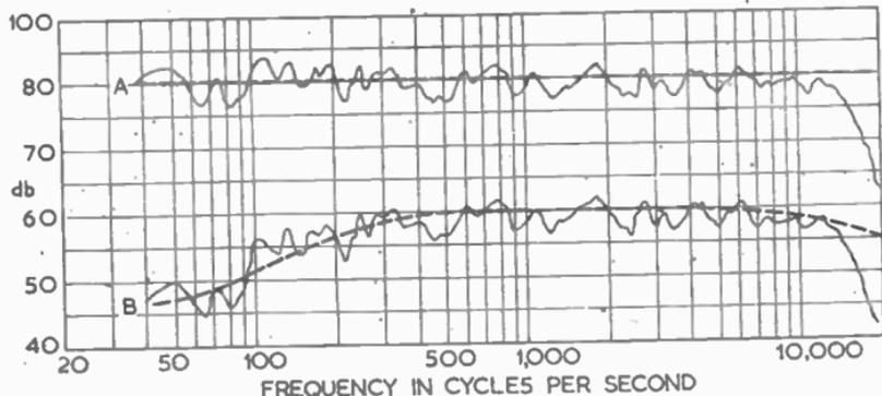
FIG. 1.—FREQUENCY RESPONSE OF HIGH-QUALITY SYSTEM MEASUREMENT AT THE EAR OF THE LISTENER IN THE LISTENING ROOM.
