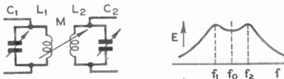
FIG. 37.—COUPLED TUNED CIRCUITS.
