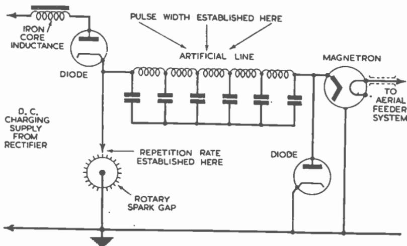
FIG. 41.—DEVELOPMENT OF HIGH-VOLTAGE, HIGH-POWER PULSES AT HIGH LEVEL.
