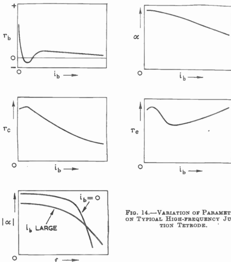
FIG. 14.—VARIATION OF PARAMETERS ON TYPICAL HIGH-FREQUENCY JUNCTION TETRODE.
