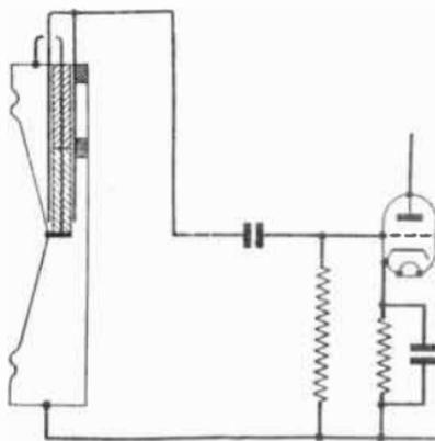
FIG. 10.—"DIAPHRAGM" TYPE CRYSTAL MICROPHONE IN CIRCUIT.
