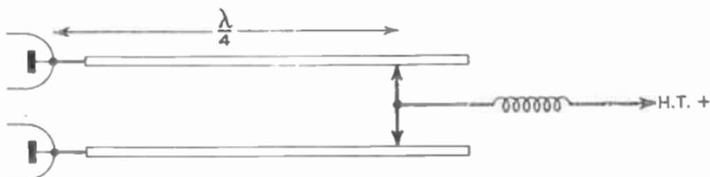
FIG. 8.—QUARTER-WAVE PARALLEL-LINE SECTION USED AS A CIRCUIT ELEMENT.
