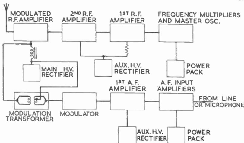
FIG. 28.—HIGH-POWER BROADCAST TRANSMITTER FED BY SEPARATE HIGH-VOLTAGE RECTIFIERS.
