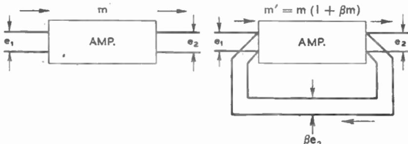
FIG. 66(a).—NEGATIVE VOLTAGE FEEDBACK.
