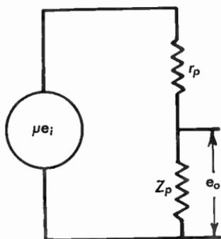
Fig. 4.25 Equivalent triode circuit.
