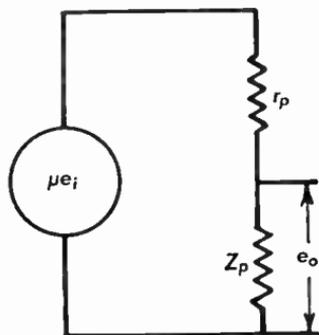
Fig. 4.25 Equivalent triode circuit.
