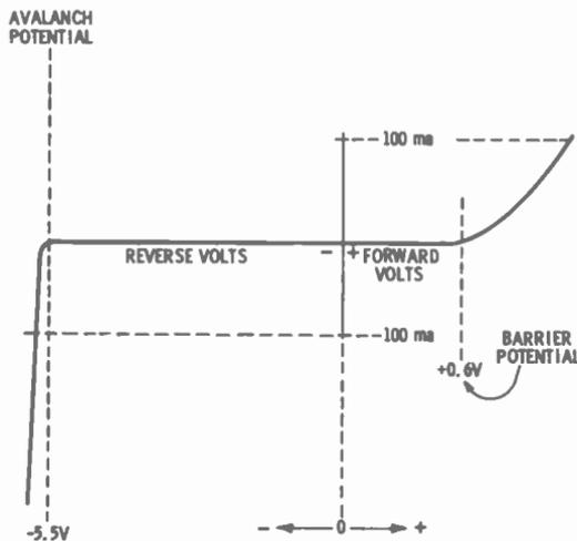
Fig. 2-11. Basic curve of 5.5-volt zener diode.
