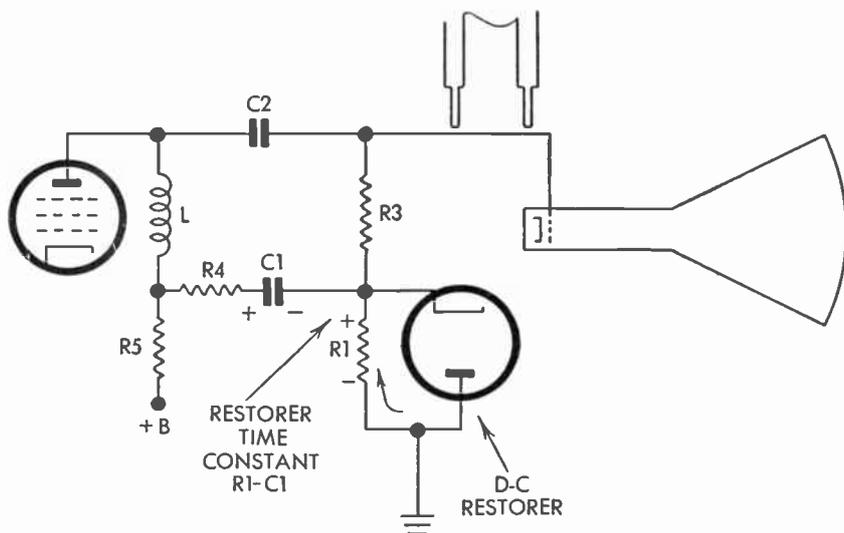
FIG. 93 Diode-Type D-C Restorer
