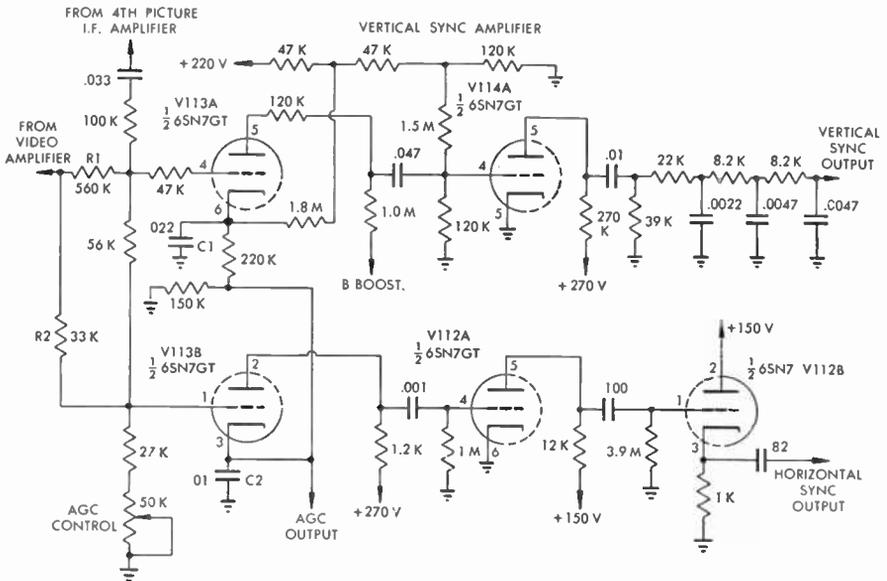
FIG. 154 RCA Sync-Separator Circuits
