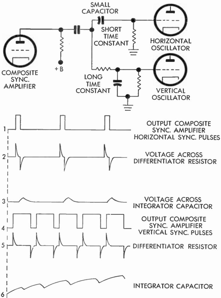
FIG. 143 Simple Inter-Sync Separation
