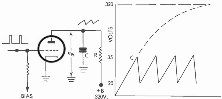
Fig. 159 Discharge-Tube Sawtooth Generator
