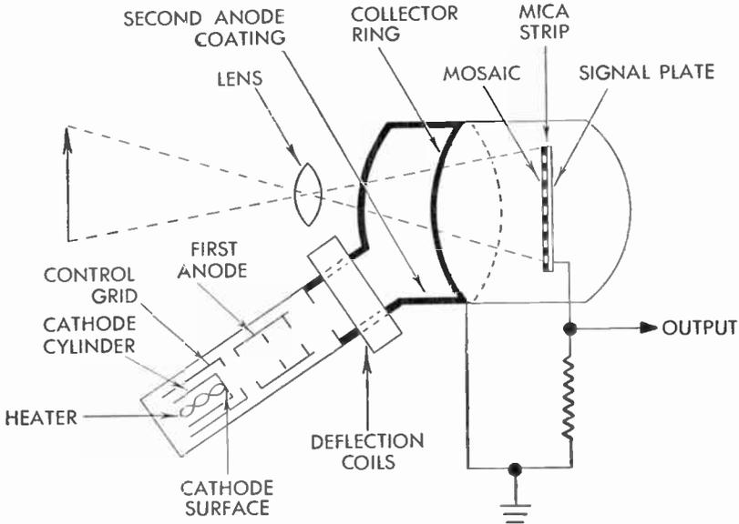
FIG. 27 Iconoscope
