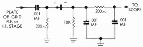
FIG. 317 Diode Probe Rectifier
