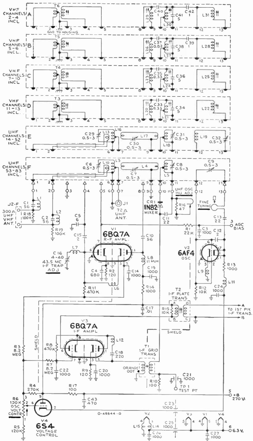
Fig. 210b RCA VHF-UHF Tuner
