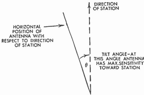
Fig. 263 Tilt-Angle Layout
