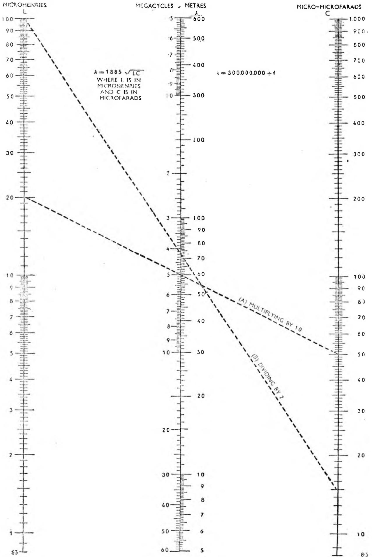
Fig. 13. ABAC I: INDUCTANCE, CAPACITANCE, FREQUENCY, WAVELENGTH
