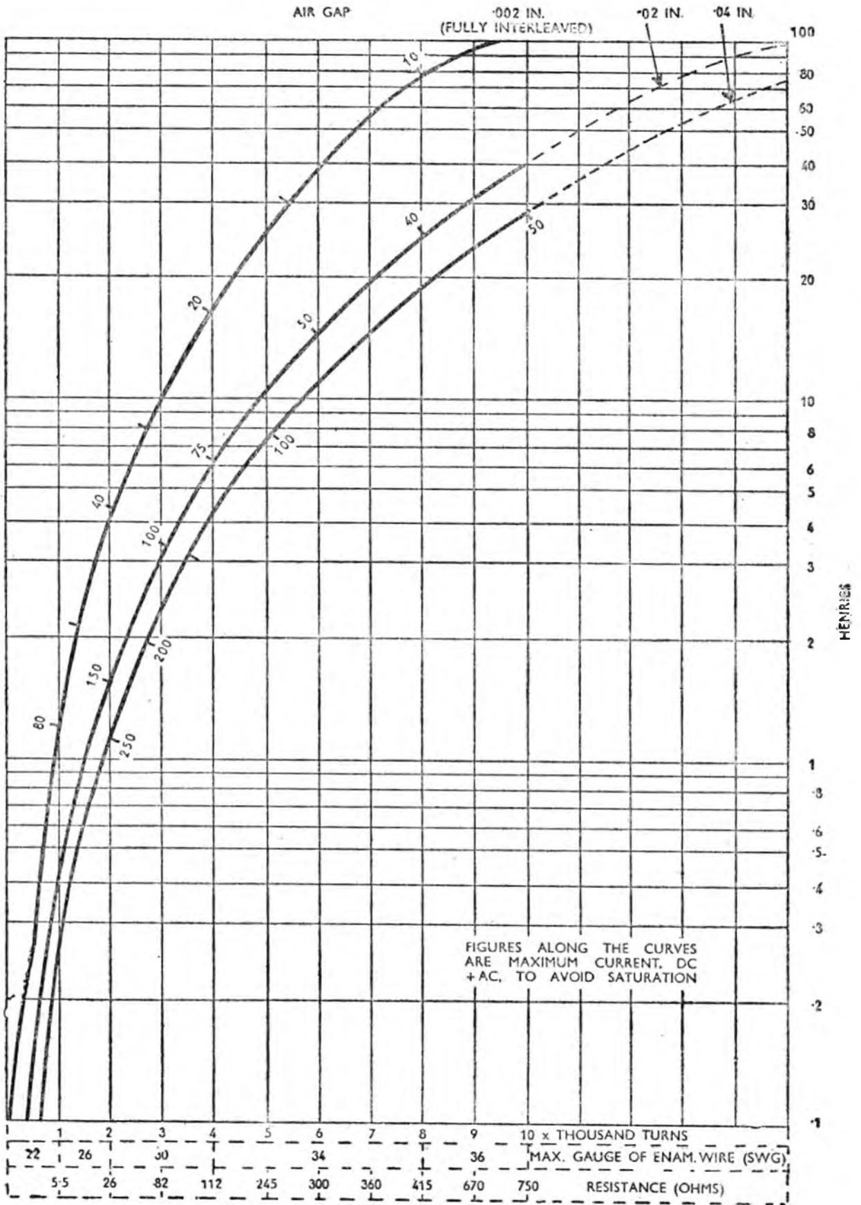
**Fig. 81. INDUCTANCE OF IRON-CORED LF CHOKES**
