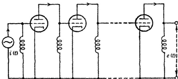
FIG. 1-18.—The  $n$ -stage inductance amplifier.
