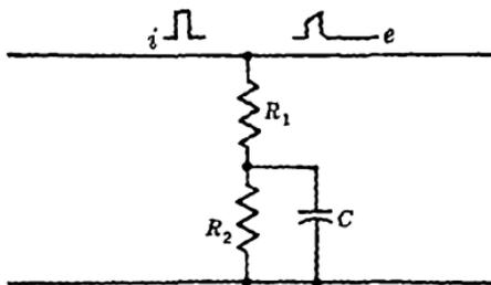
FIG. 3-2.—Decoupling circuit.
