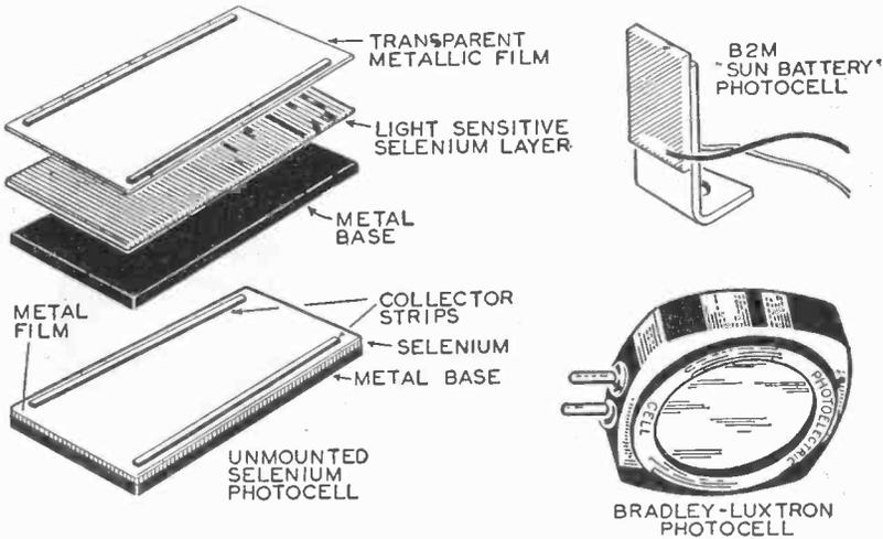
**SELENIUM PHOTOELECTRIC CELL CONSTRUCTION**
