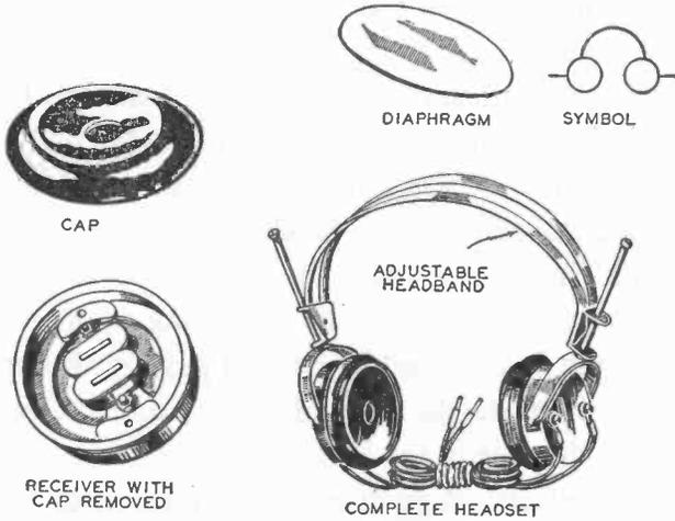
**ELECTROMAGNETIC TELEPHONE HEADSET FOR RADIO USE**
