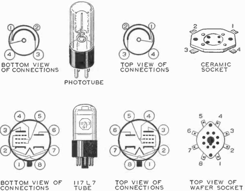
**CETRON CE23 PHOTOTUBE AND 117L7 COMBINED AMPLIFIER AND HALF-WAVE RECTIFIER TUBE**
