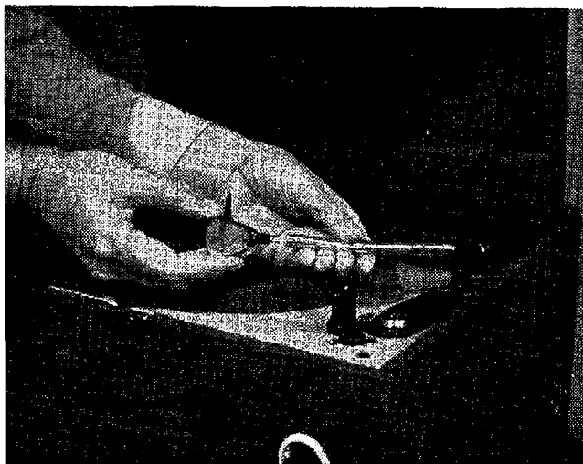
Přístroj pro dlouhohrající desky má nové, lehké a výměnné přenosky se safírovým hrotem.
