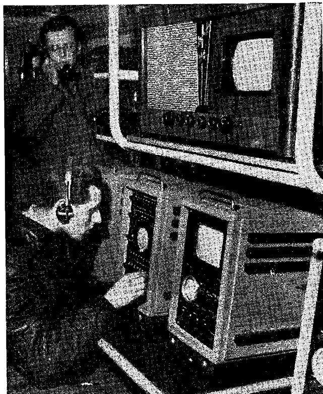
Kontrolní a režijní jednotky v autobuse. Nad nimi kontrolní přijímač.
