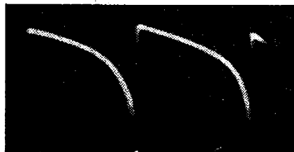
Obr. 2: Průběh napětí na g_2 elektronky 6L43.
