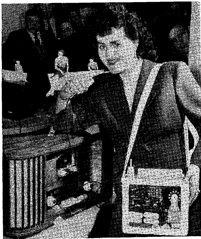
Vlevo přijímač „Consul“ s osmidenními splnacími hodinami. Vpravo: velmi lehký přenosný reportážní magnetofon s pohotovostními výměnnými cívkami (nahole) a malým reportážním mikrofonem.
