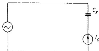
Obr. 1. Měření kapacity kondenzátorů proudovou metodou – princip
