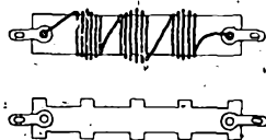
Obr. 6. Vř. tlumivka se navine buď na válcovou kostřičku nebo na proužek pertinaxu
