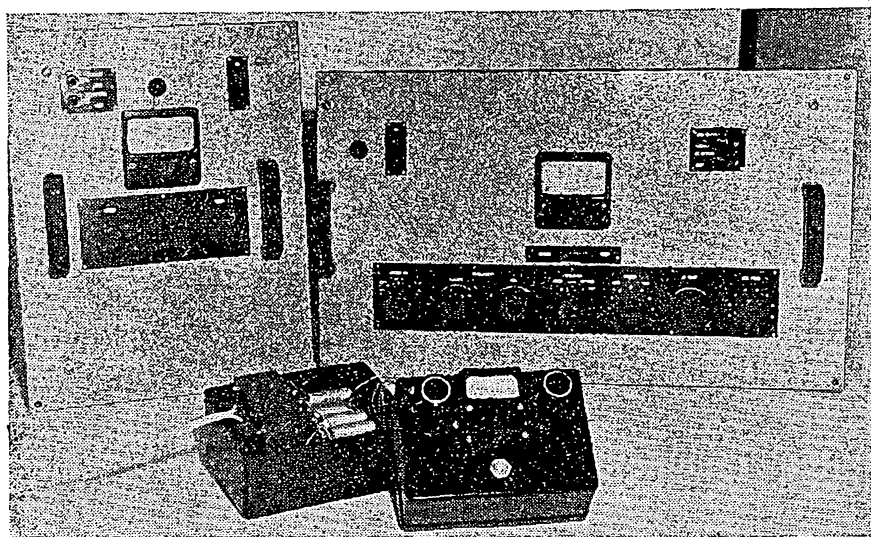
Obr. 5. Porovnání tranzistorového klíčovače se stejným zařízením profesionálním, kterému se plně vyrovná. Vpravo vzadu klíčovací jednotka přijímače ZVP 2, vlevo stejnosměrný můstek téhož zařízení. Uprostřed dole tranzistorový klíčovač
