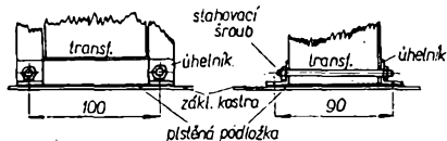
Obr. 13. Připevnění sloupového transformátoru ke kostře
