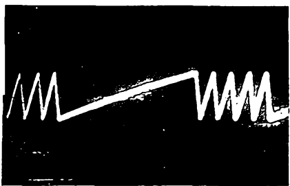
Obr. 11. Průběh napětí na kondenzátoru C8 (C11). Kódér je čtyřkanálový. Měřítka: y = 0,5 \text{ V/cm} , x = 2 \text{ mV/cm}
