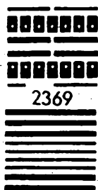
Obr. 9. Příklad obrazců z archu Typofix č. 2369 (NDR) k individuální přípravě plošných spojů – modulů s obvody TTL
