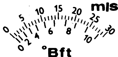
Obr. 9. Provedení stupnice ručkového měřidla rychlosti větru (zvětšeno 1,5x)
