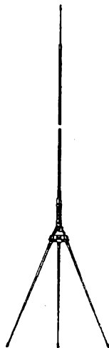
Obr. 7. Profesionální anténa GP typu SIGNAL KEEPER 27 se zkráceným zářičem (130 cm), prodlužovací cívkou a redukovými radiálami, kterou dodává německá firma PAN
