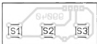
Obr. 6a. Osazení desky tlačítek.
