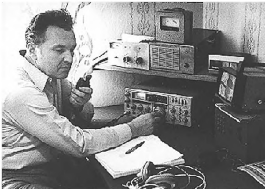
OK2QX a jeho zařízení, které používal v letech 1985 až 1994: japonský transceiver YAESU FT-107M, nahoře vlevo anténní člen, vedle zdroj, na něm měřič síly pole
