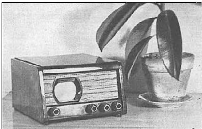
Amatérsky zhotovený televizor z počátku 50. let, sestavený převážně z válečného radiomateriálu. Obrazovka je typu LB8 z radaru. Autorem konstrukce je A. Rambousek
