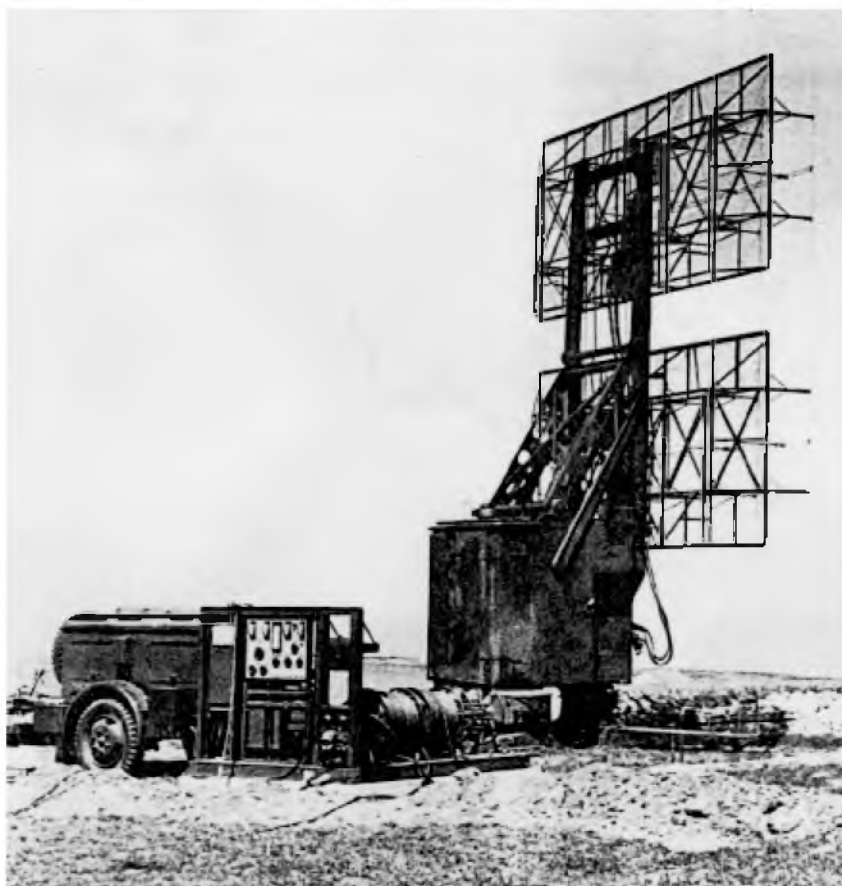
Obr. 19. Sériový radar firmy GEMA, typ „f-Lafette FREYA“ v pohotovostním stavu na zkušebně v roce 1940
