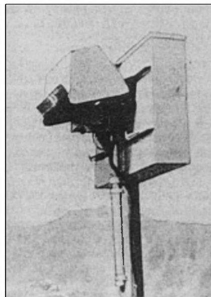
Obr. 7. Směrový přístroj „Krabbe“ 375 až 420 MHz
