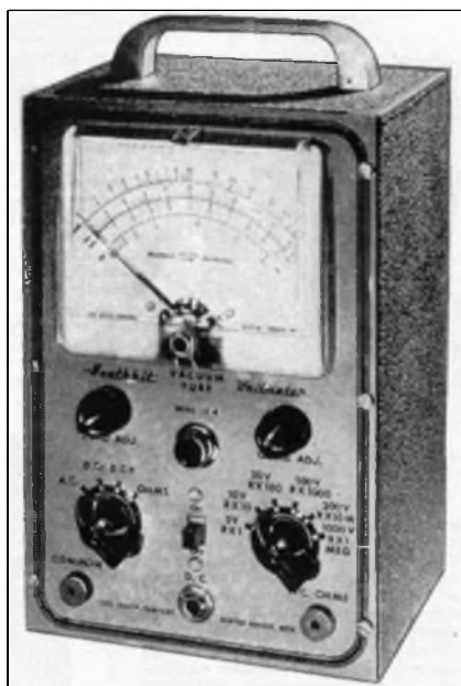
Elektronkový voltmetr Heathkit V-4. Vlevo pohled zepředu, vpravo schéma zapojení.
