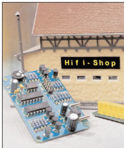
Obr. 2. Příklad realizace reklamního nápisu a řídicí elektroniky
