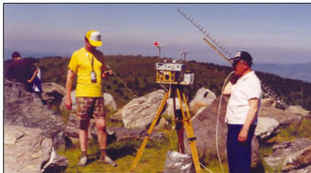
Obr. 3. Zkouška nové antény pro pásmo 2320 MHz spolu s OK2BTF na kótě Dlouhé stráně, nadmořská výška 1350 m
