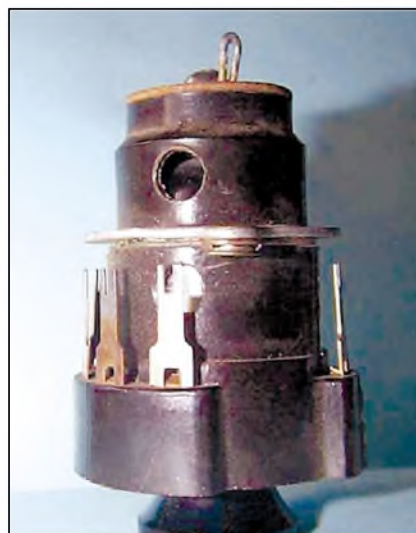
RV12P2000 v „lehkém“ provedení soklu (plechový upevňovací kroužek, drátová pružina se dotýká stínicího pásku na elektronece)
