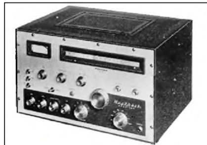
Obr. 5. Zdokonalený RX-1 pro KV pásma. Možnost poslechu CW, AM a dokonce SSB, BFO a další vylepšení. Prodával se také jako stavebnice
