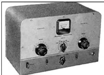
Obr. 4. První vysílač pro radioamátorské účely AT-1, který se prodával už sestavený
