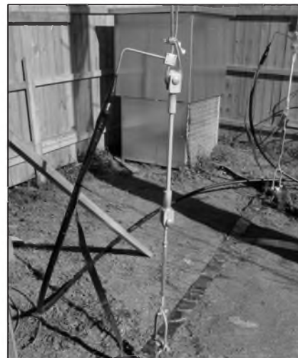
Obr. 3. Detail napájení dvou částí zářiče antény Kinstar
