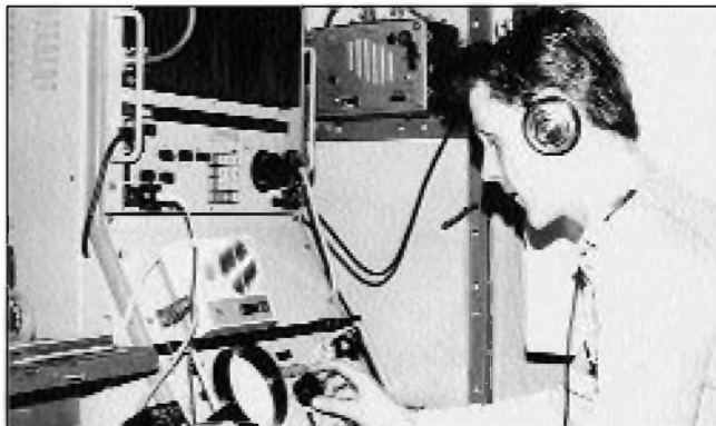
Obr. 2. Krátkovlnný zaměřovací přijímač REV-259 na zaměřovacím stanovišti dessauského rádiového pluku
