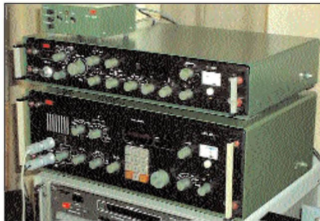
Obr. 5. Přijímač EKD-300 s dálkopisným přídavkem EZ-100 z produkce RFT nahrazoval zastaralý sovětský přijímač R-250 pro potřeby rádiového průzkumu
