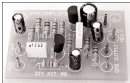
Obr. 1. Foto předzesilovače zhotoveného podle původní dokumentace
