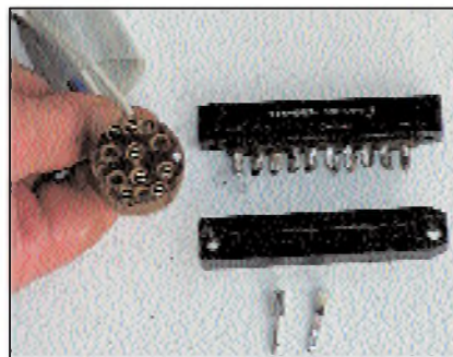
Obr. 6. Vľavo konektor pre napájací zdroj, vpravo rozobraný nožový konektor
