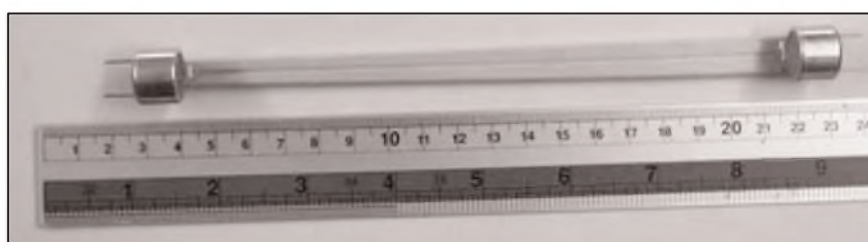
Obr. 3. Umístění ultrazvukových měničů na držáku
