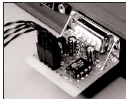
Obr. 5. Připojení teploměru k počítači
