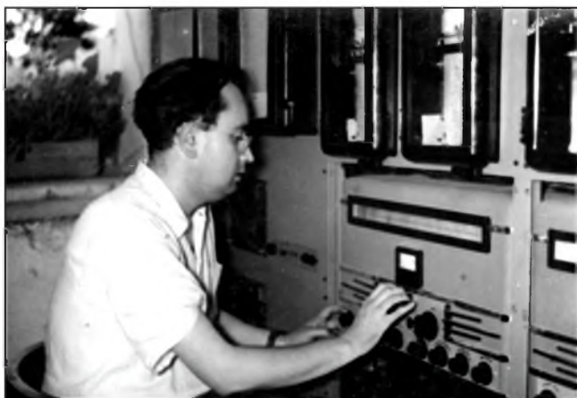
V útrobách roubené chalupy bylo vybudováno ionosférické pracoviště. Pro předávání zpráv sloužil stránkový dálnopis RFT. Na obrázku vlevo je sedící OK1FA u aparatury pro registraci rozhlasové stanice Brašov. Na obrázku vpravo stojí OK1FA kontroluje nahrávku hvizdů na magnetofonu „Stuci“
