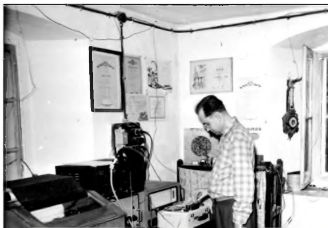
V útrobách roubené chalupy bylo vybudováno ionosférické pracoviště. Pro předávání zpráv sloužil stránkový dálnopis RFT. Na obrázku vlevo je sedící OK1FA u aparatury pro registraci rozhlasové stanice Brašov. Na obrázku vpravo stojí OK1FA kontroluje nahrávku hvizdů na magnetofonu „Stuci“
