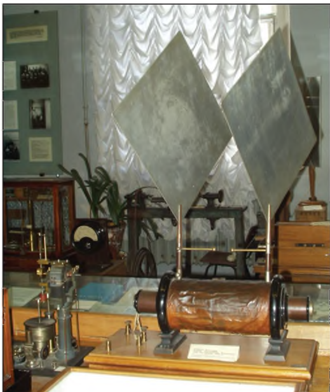
Obr. 6. Hertzův dipól u Popovova vysílače
