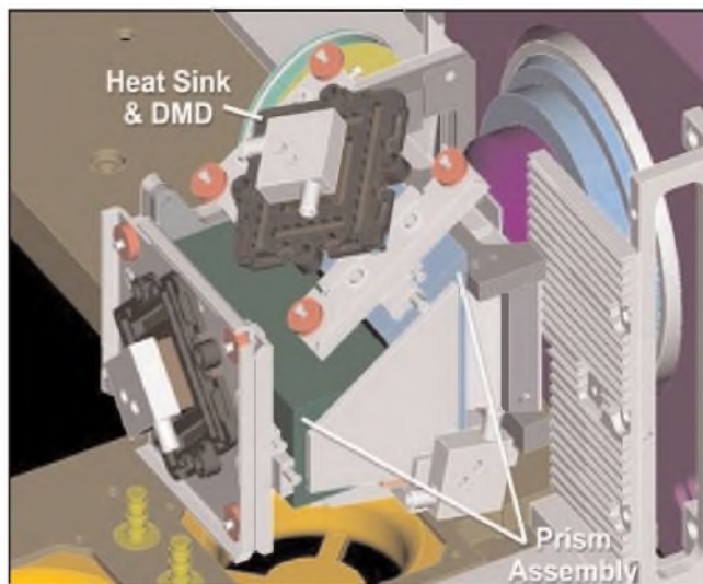
Detail optického systému
