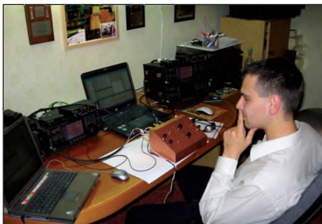
Martin Karasz, OK2EZ, se podílí na technickém vybavení našeho týmu jako konstruktér ovládacího reléového „Magic boxu“ celého pracoviště, tj. dvou transceiverů, dvou PC, anténních přepínačů, interfejsů, filtrů atd. Většinu potřebných součástí dodala slovenská firma MicroHAM a v době naší uzávěrky již probíhaly testy v síti s deníkem N1MM
