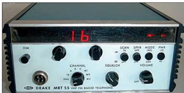
Obr. 23. FM transceiver pro námořnictvo, typ MRT-55
