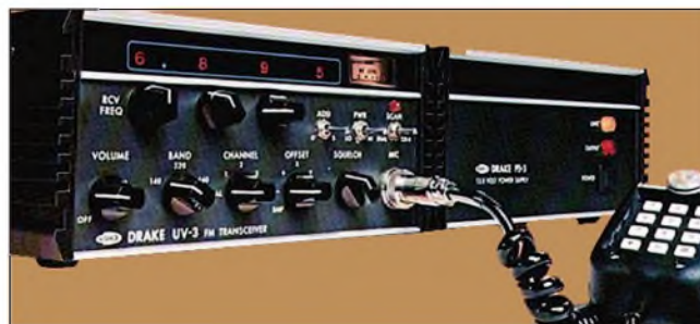
Obr. 20. První FM transceiver se syntézou kmitočtu, typ Drake UV-3, rok výroby 1978
