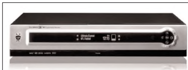
Obr. 6. HD DVR (harddiskový rekordér) umožňuje nahrávání jak z DVB-T, tak i z kabelové sítě v normálním i HD rozlišení
