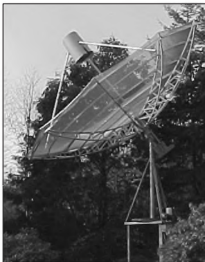
Obr. 1, 2. Amatérský radioteleskop pro pásmo 1420 MHz, popsáný v knize Johna Fieldinga, ZS5JF, „Amateur Radio Astronomy“. Vydala RSGB v roce 2006
