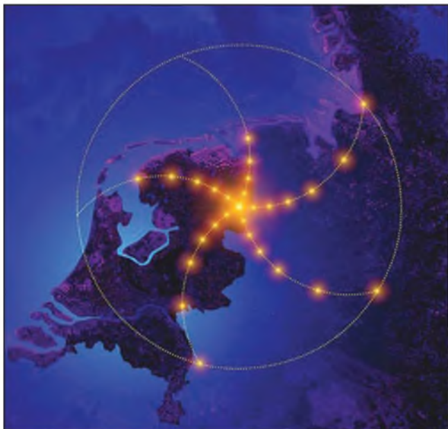
Obr. 7. Soustava LOFAR (Low Frequency Array) pro pásmo 10 až 240 MHz: každá „stanice“ bude tvořena více než stovkou samostatných antén, radioteleskop LOFAR bude obsahovat více než 100 takovýchto stanic a jeho efektivní sběrná plocha dosáhne 1 km 2 . Viz http://www.lofar.org/
