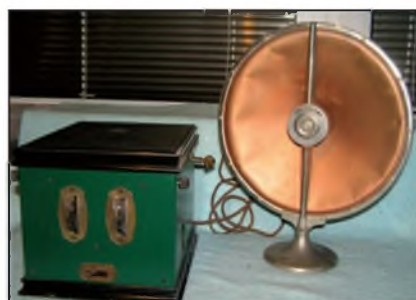
Obr. 5. Jeden z prvních přijímačů holandské fy Philips, přímozesilující typ 2514 z r. 1928 s talířovým reproduktorem téhož výrobce (soukromá sbírka, nálezořový stav)
