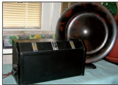
Obr. 5. Jeden z prvních přijímačů holandské fy Philips, přímozesilující typ 2514 z r. 1928 s talířovým reproduktorem téhož výrobce (soukromá sbírka, nálezořový stav)
