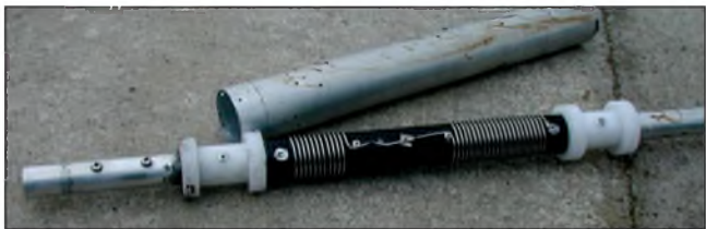
Obr. 1, 2. Trap uvnitř. Na kousku (10 mm) hliníkové trubky (vpravo od bílého plastu) drží celá vertikální část antény
