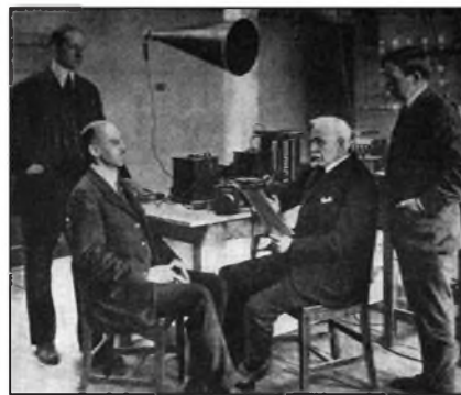
Obr. 3. Šíření osvěty „radiofonem“ - živé vysílání osvětové přednášky v r. 1923. Trychtýř nad stolem s přístroji je mikrofón [6]. České označení „rozhlas“ bylo vymyšleno až v r. 1924
