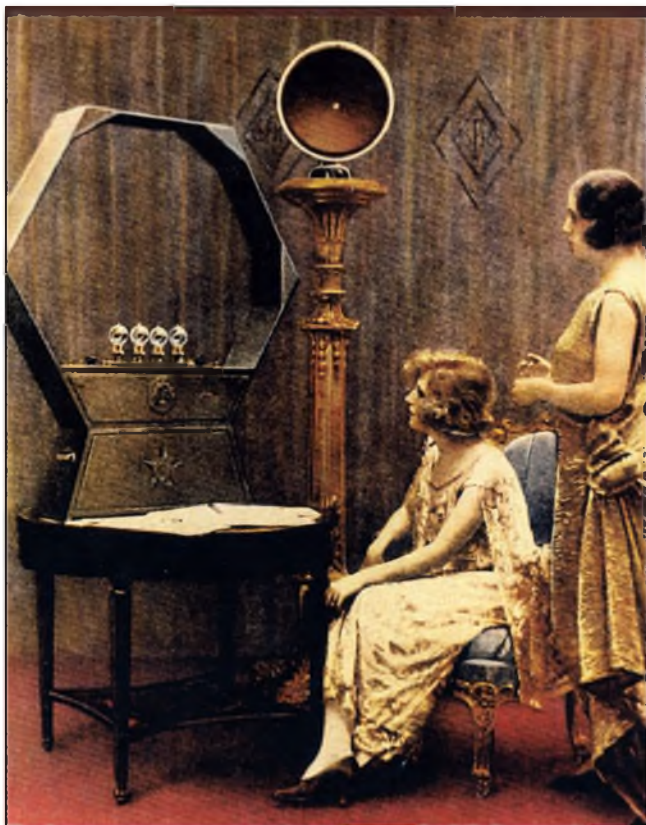
Obr. 4. Čtyřlampovka z r. 1923 „Radiola“ s rámovou anténou, výrobek francouzské firmy S. F. R. [6] - vlevo (obr. převzat z Antique Radio Magazine No 31)
