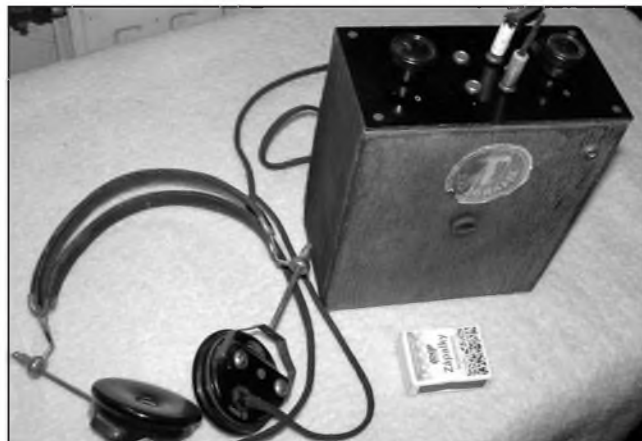
Obr. 8. Bateriový jednolampový přijímač „Weekend“ pardubické radiotovářny Telegrafia (1934). Poslouchalo se na sluchátka. Rámová anténa byla navinuta pod krycím plátnem obvodu skřínky (soukromá sbírka, nálezořový stav)
