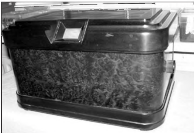
Obr. 7. Přímozesilující 5+1 lampový přijímač „Super inductance“ 720A, vyráběný hloubětínskou pobočkou fy Philips v r. 1931 až 1932. Napájení ze střídavé sítě. Skříňka je z bakelizovaného papíru, celuloidová stupnice je válcová bez názvů vysíláčů (soukromá sbírka, nálezořový stav)
