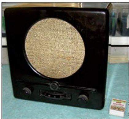
Obr. 9. Německý přijímač D.K.E. (Deutscherkleinempfänger, asi 1938), přezdívaný také „Goebbelsova tlama“. Díky záměrně omezené citlivosti byl schopen i na dobrou anténu přijmu pouze silného místního vysílače, taková bezdrátová obdoba pozdějšího „rozhlasu po drátě“. Vyráběla se také verze na baterie (soukromá sbírka, restaurováno)
