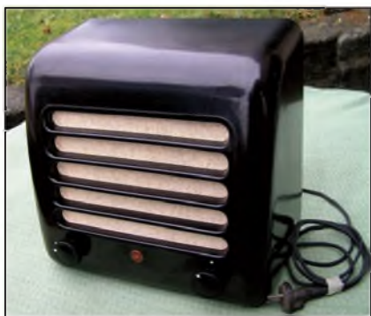
Obr. 15. Síťovou přímotesilující dvou-lampovku T713 v bakelitové skříňce vyráběla Tesla Bratislava (dříve Tung-sram) v letech 1948-49. Osazení: EF12, EL11, AZ11. Tento jednoduchý přijímač neměl obvyklou stupnici s ukazatelem. (Soukromá sbírka, restaurováno)
