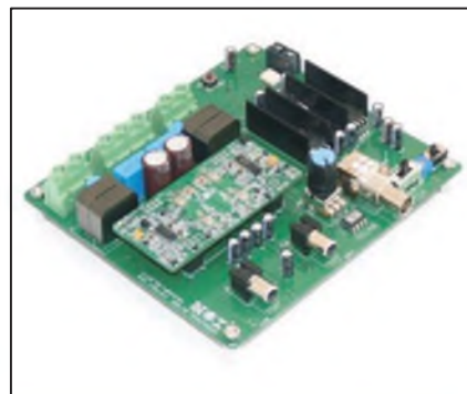
Obr. 1. Referenční zesilovač 2x 120 W ve třídě D firmy International Rectifier
