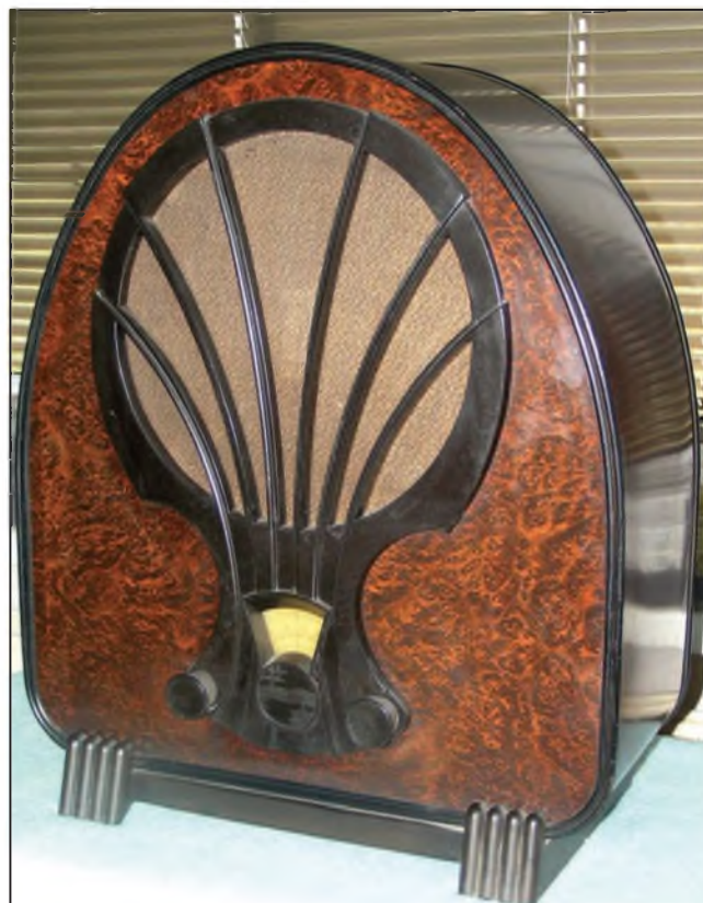
Obr. 16. Typická Philipsova „kaplička“ 830A „Junior“ z r. 1932. Přímotesilující dvouobvodový 4+1 lampový přístroj s elektromagnetickým reproduktorem, zvuk asi jako hlasitě hrající lepší telefonní sluchátko. (Soukromá sbírka, restaurováno)
