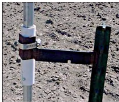
Obr. 2. Upevnění prvku k držáku musí zaručovat minimální kapacitu
