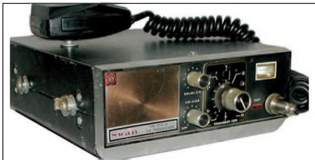
Obr. 10. SWAN FM 2XA - zařízení pro pásmo 2 m
