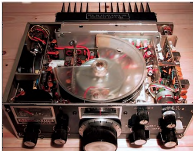
Obr. 11. Transceiver ATLAS 210 uvnitř (vpravo)
