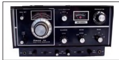
Obr. 12. Swan SS-200A, poslední transceiver, vyrobený ve spolupráci s Cubic Co.
